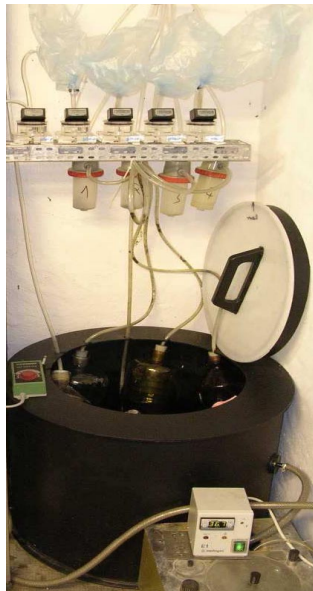
Abbildung 1 und 2: Laborbiogasanlage der TU Bergakademie Freiberg (linke Abb.) 3-Liter-Fermenter mit Kartoffelmonosubstrat (rechte Abb.)
