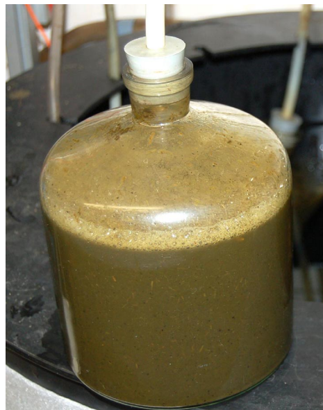
Abbildung 1 und 2: Laborbiogasanlage der TU Bergakademie Freiberg (linke Abb.) 3-Liter-Fermenter mit Kartoffelmonosubstrat (rechte Abb.)
