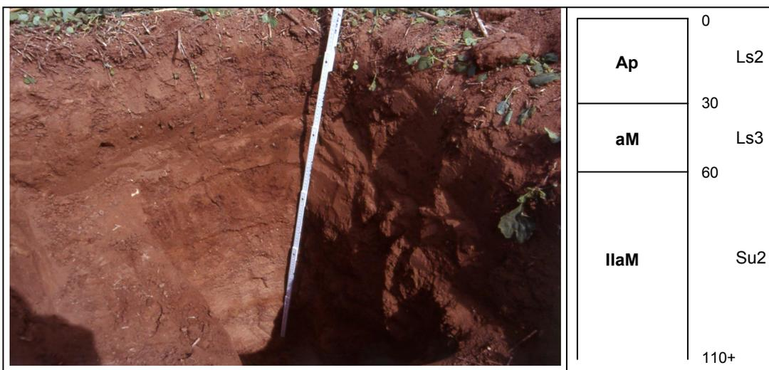
**Abbildung 6: Bodenprofil „Am Park“ auf niedrigem  $EC_a$ -Wert (36 mS/m) mit schematischer Ansprache der Horizonte (Tiefenangaben in cm)**
