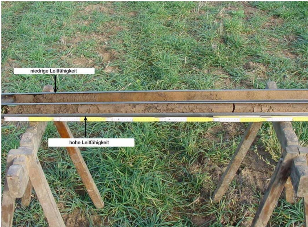
Abbildung 110: Bohrkern aus 0 ... 120 cm Tiefe bei niedriger und hoher Leitfähigkeit
