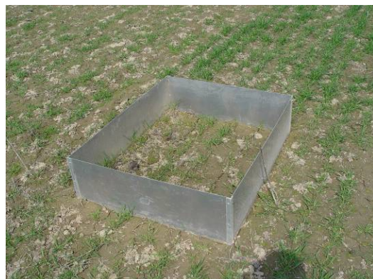
Abb. 25: Aluminium-Rahmen (Flächeninhalt: 1 m 2 ) für den Enclosure-Exclusion-Test
