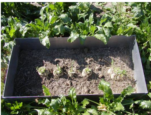
Abb. 25: Aluminium-Rahmen (Flächeninhalt: 1 m 2 ) für den Enclosure-Exclusion-Test
