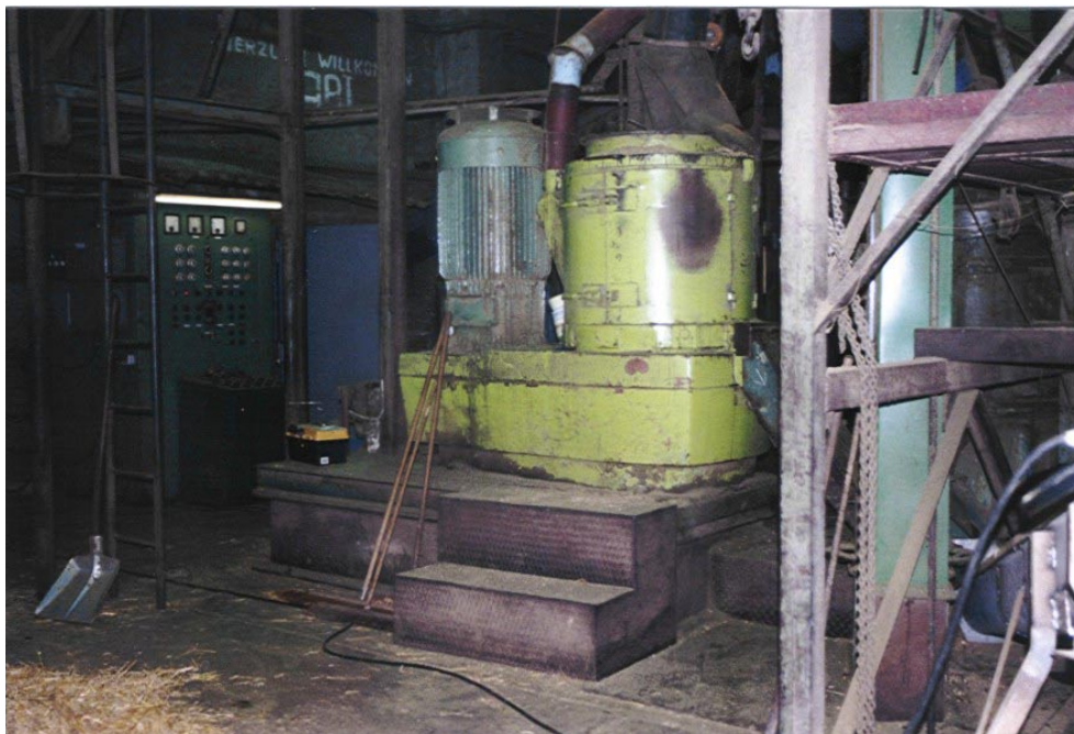
Abb. 26: Kollergang-Press (rechts) mit Elektromotor (Mitte) und Schaltzentrale (Landwirtschaftliche Trocknungs- und Dienstleistungs-GmbH Grimma)
