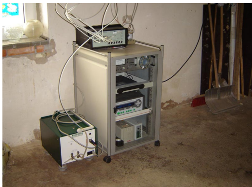
Abb. 9: Messstation für Druck, Gas, Volumenstrom
