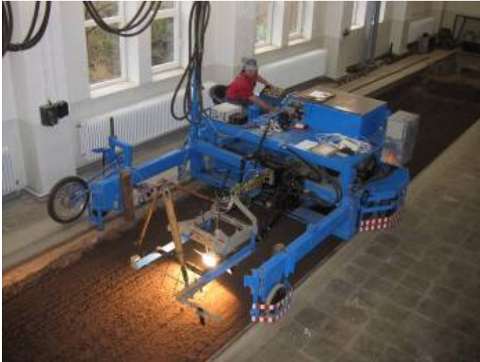
Abbildung 1: Versuchsanordnung zur Bestimmung der Bodenbewegung beim Striegeln
