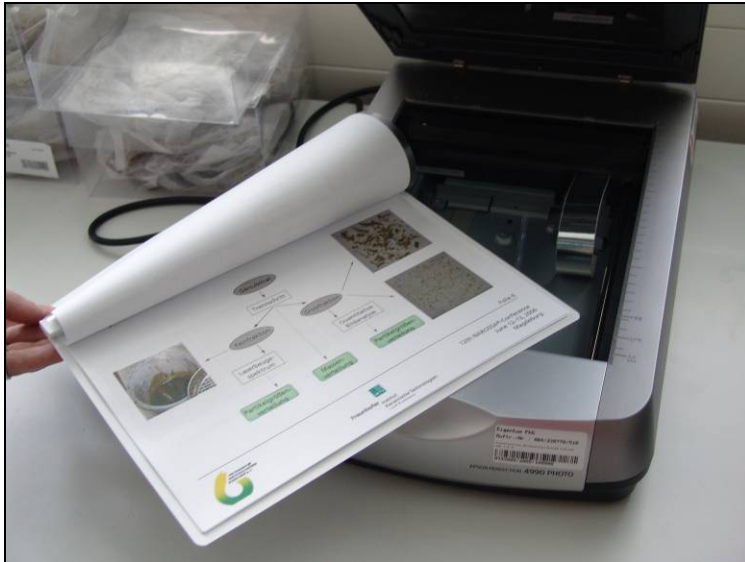
Abbildung 15: Substratanalyse mittels Scannermethode
