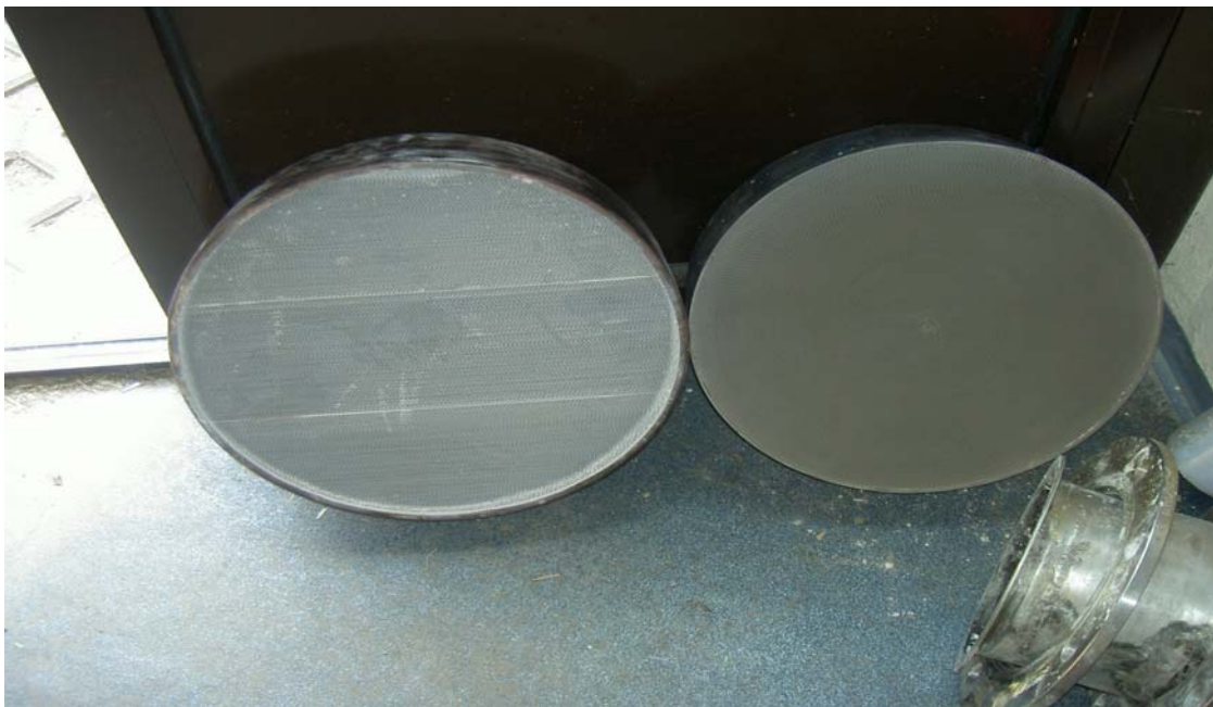
Abbildung 11: Katalysator vor und nach dem Einsatz
