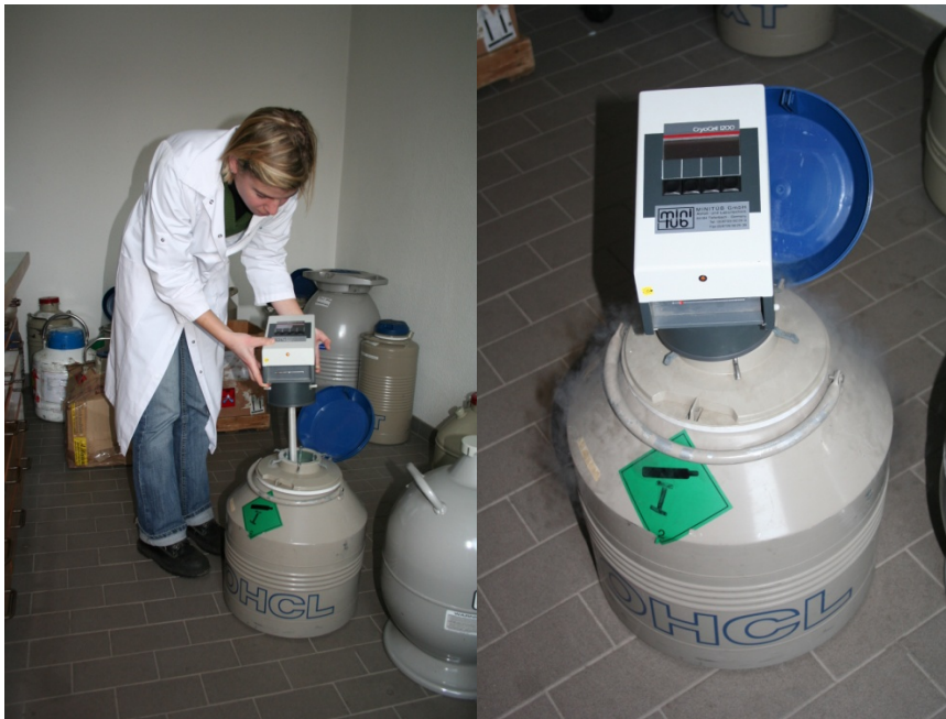
Abbildung 5: Kryokonservierung von Embryonen in N 2 mithilfe eines programmierbaren Einfriergeräts
