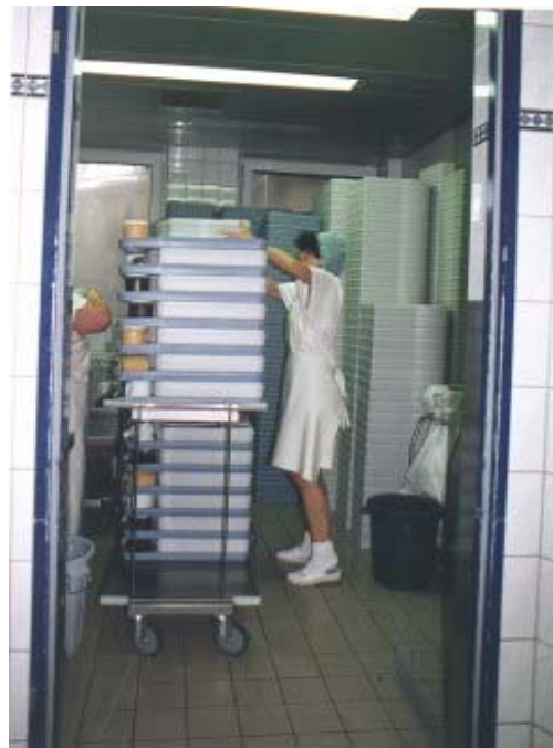
Bild 10: Arbeitshöhen von 1,50m bis 1,80m (6 bis 8 Tablettts übereinander) treten während der Spitzenzeit regelmäßig auf
