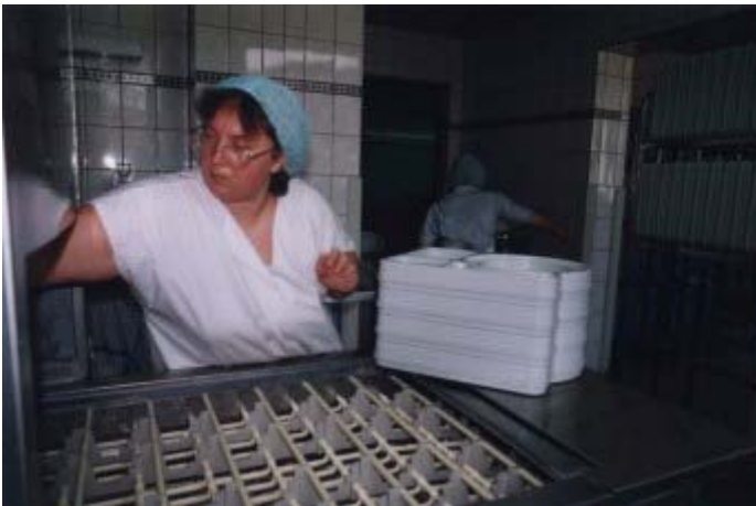
Bild 11: Das vermeintlich schnellere Arbeiten durch tiefes Hineingreifen in die Spülmaschine bewirkt wiederholt eine unnötige Belastung der Wirbelsäule
