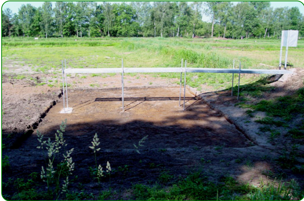
Abbildung 1-6: Pro Versuchsteich wurden für den Aufbau der Netzgehege zwei Felder ge- ebnet, auf denen die Gehege bodenschlüssig errichtet wurden.
