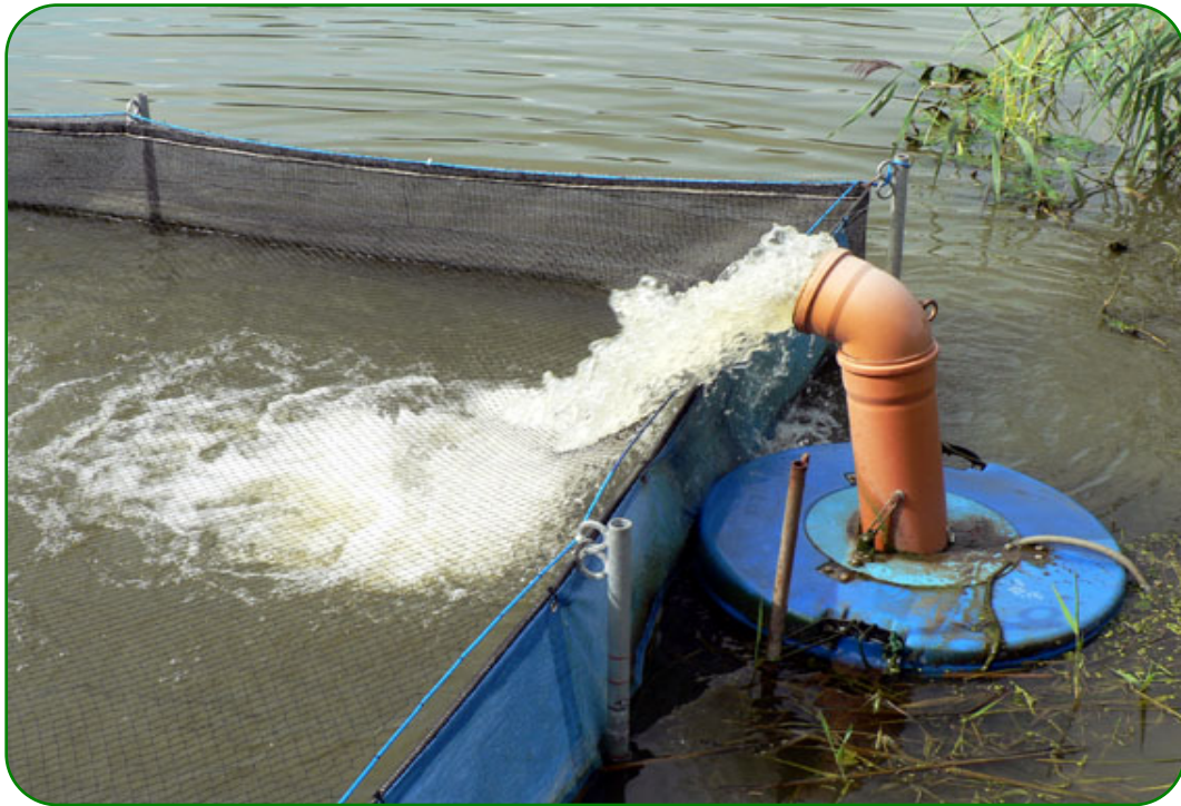
Abbildung 27: Umgebauter Strömungsbelüfter mit einem Förderrohr, um Höhenunterschiede besser überwinden zu können
