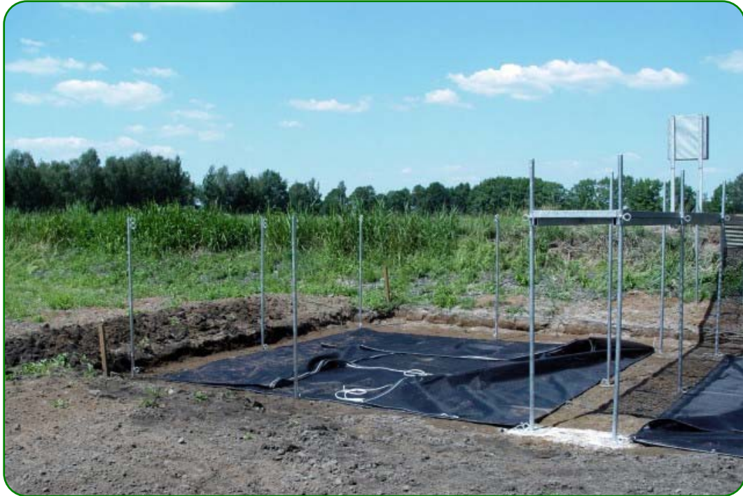
Abbildung 1-8: Jeweils fünf Stangen und der Steg dienen der Befestigung der Gehege. Rechts der Schaltschrank für die Elektroinstallation und die Messtechnik
