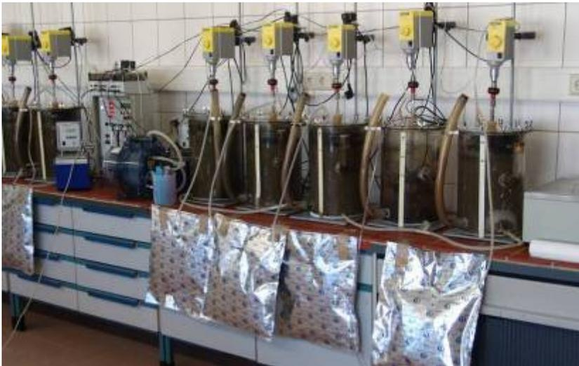
**Abbildung 21: Laborfermentieranlage mit Gasmessung und Thermostat im Labor der Fa. BTN Biotechnologie Nordhausen GmbH**
