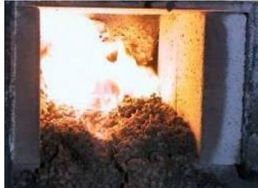
**Abbildung 28: Versuchsaufbau mit KSM 275-18C, Blick in den Brennraum**
