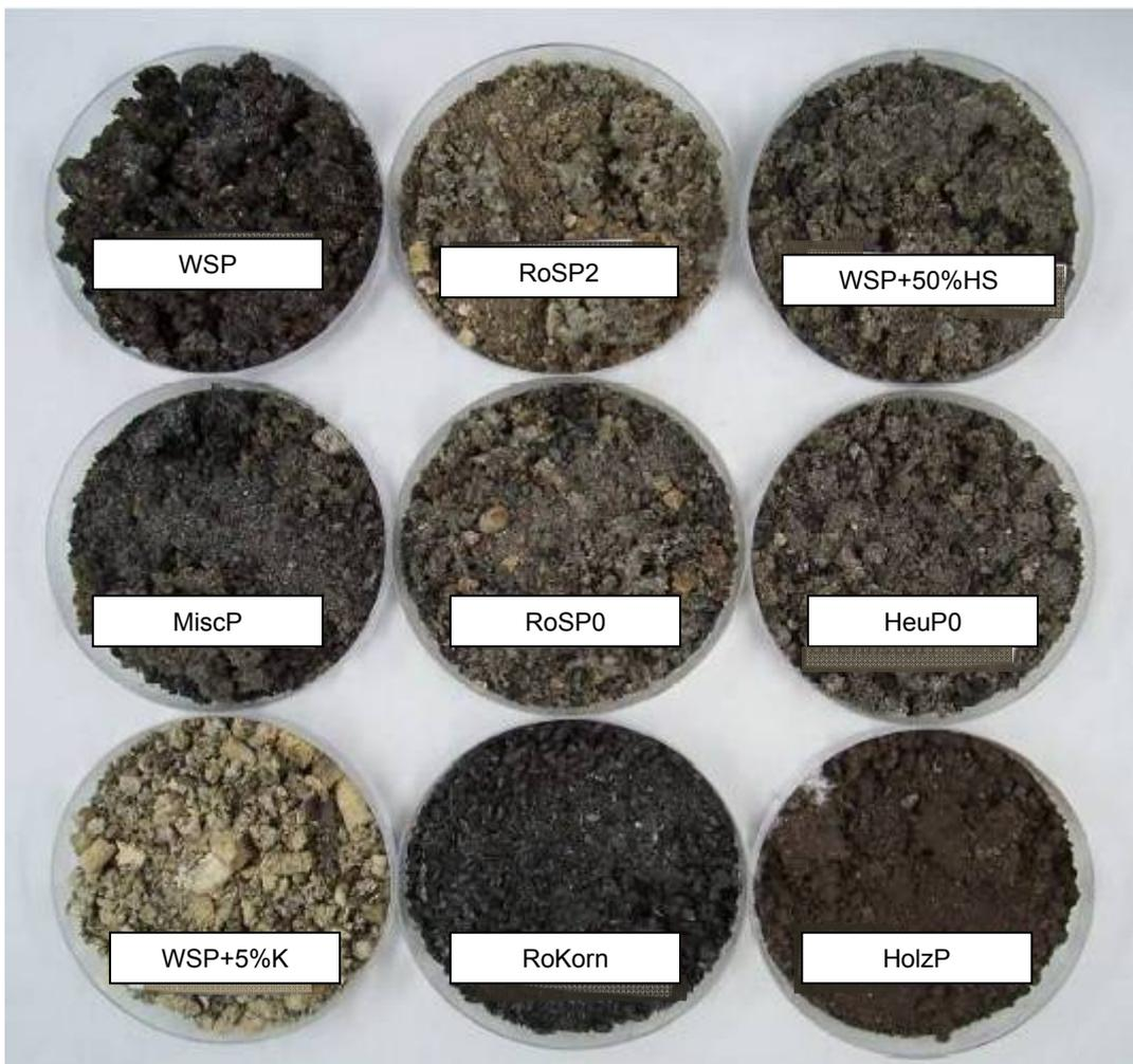
**Abbildung 40: Verbrennungsaschen der eingesetzten Brennstoffe im Guntamatic Power-Corn 30**
