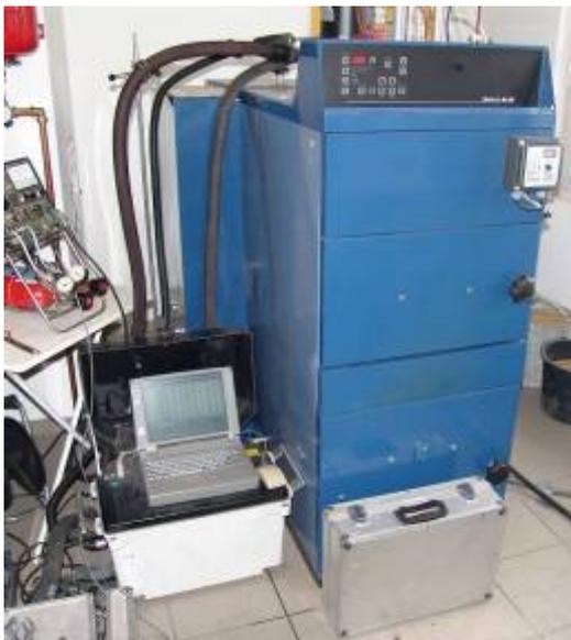
Die Durchführung der Emissionsmessungen übernahm die Firma AIRTEC Gesellschaft für Umweltmessungen mbH Leipzig. Der Kessel wurde für die Verbrennung von Holzpellets und Getreide sowie Holzhackschnitzel (Typ F mit Rührwerk) konzipiert. Er besteht aus Brennkammer und Vorratsmagazin. Mit einer Förderschnecke wird das Brenngut aus dem Vorratsbehälter in den Feuerraum transportiert. Die Intervalle, in denen die Schnecke arbeitet, sind regelbar entsprechend der abgeforderten Wärmeleistung.
