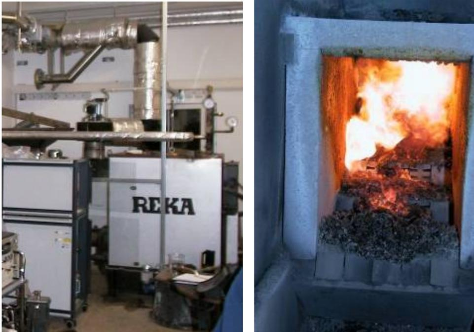
**Abbildung 26: Versuchsaufbau mit Kessel Reka HKRST 30/3, Brennraum mit Stufenrost**
