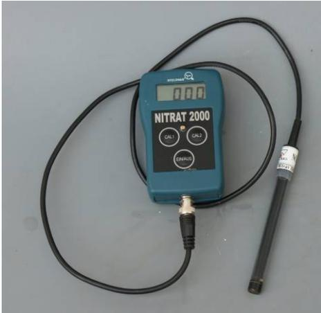
**Abbildung 7: Messgerät Nitrat 2000 mit ionenselektiver Sonde**
