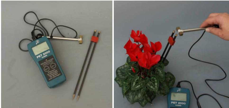
**Abbildung 13: Einsatz von PE-KT-Sonden**
