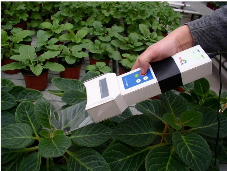
**Abbildung 25: Messung der Chlorophyllfluoreszenz mit dem PPM-Messgerät der Firma EARS (Niederlande)**
