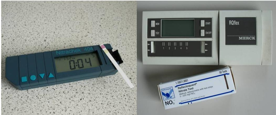
**Abbildung 6: Reflektometer zur Nitratbestimmung Nitrachek 404 und RQflex®**
