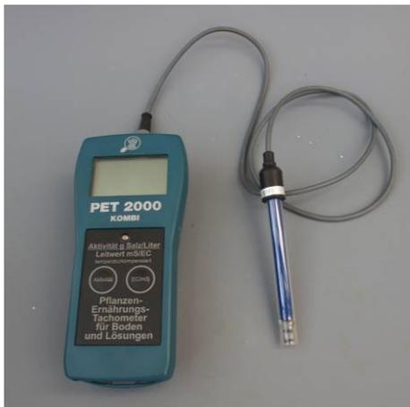
**Abbildung 1: Leitfähigkeitsmessgerät**
