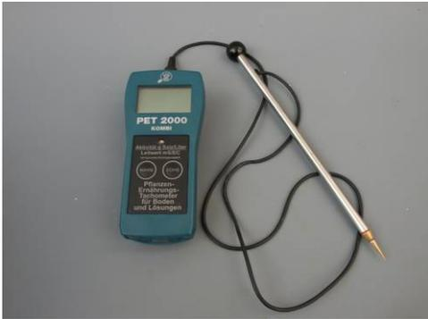
**Abbildung 11: Aktivitätsmessgerät**
