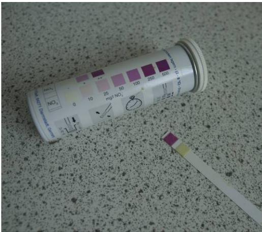
**Abbildung 5: Merckoquandt® Nitrat-Teststreifen**
