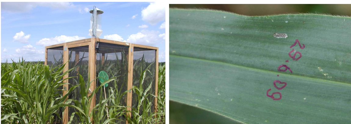
Abbildung 41: Käfig zur Kontrolle der Eiablage und des Raupenschlupfes
