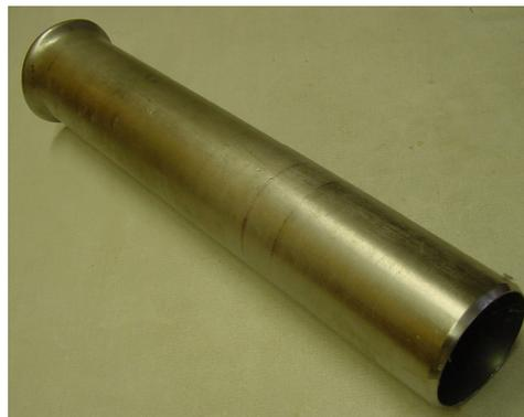
**Abbildung 12: Zylinder zur Bodenprobennahme**
