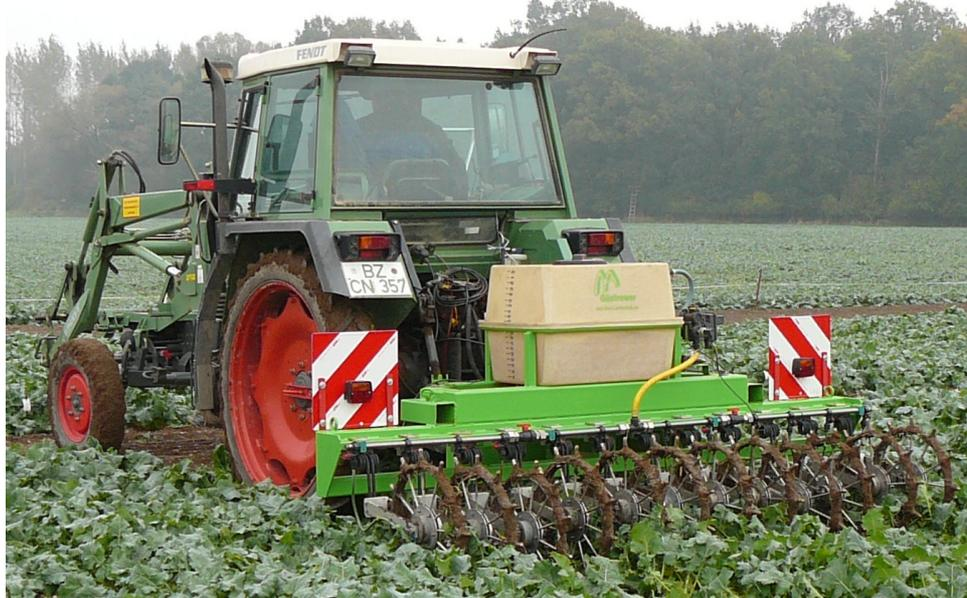
**Abbildung 8: Parzelleninjektionsmaschine mit Sternrädern**
