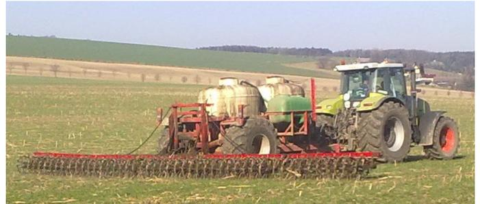
**Abbildung 6: Injektionsmaschine mit Sternrädern (Foto: SCHILLER)**
