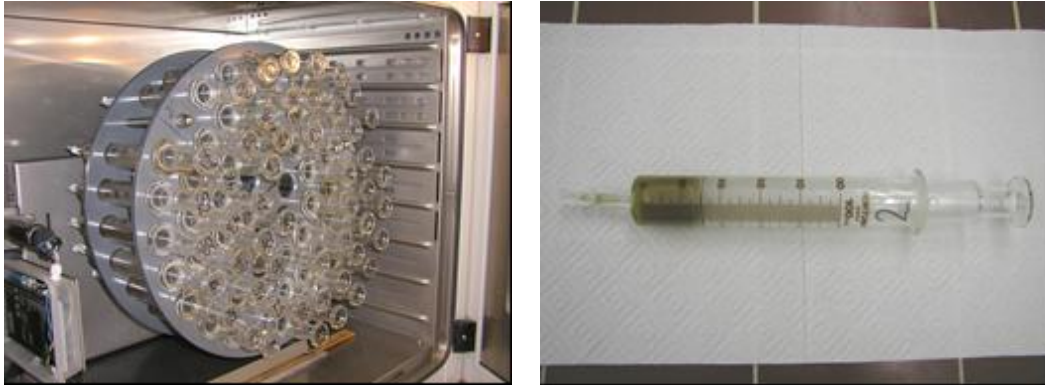
Abbildung 2: Links Rotor mit Kolbenprobern im Inkubationsschrank; Rechts einzelner Kolbenprober mit Pansensaft und Inkubationslösung
