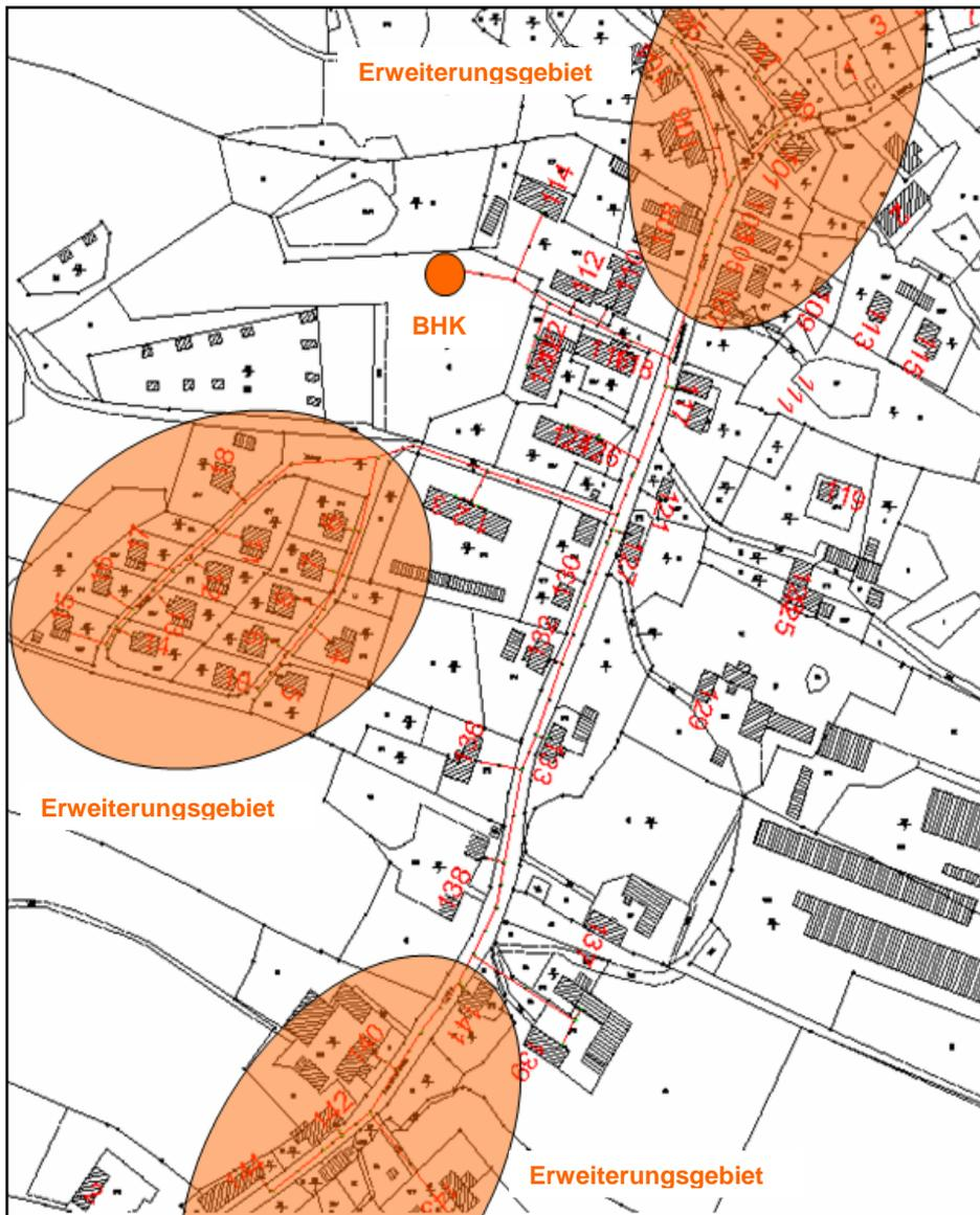
**Abbildung 5: Nahwärmenetz mit Erweiterungsgebieten**
