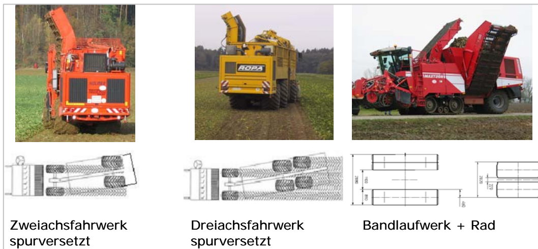
Abbildung 1: Fahrwerke und Überrollungsmuster der im Versuch eingesetzten KRB 6
