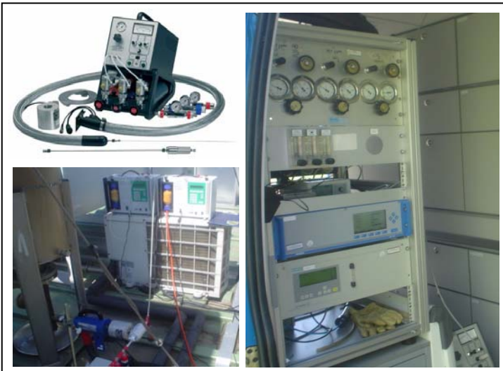
Abbildung 5: Flammenionisationsdetektor „FID-BA 3006“ der SICK MAIHACK GmbH /8/ (oben links), Abgaskamin mit eingebrachter Abgasmesssonde (unten links), im Messwagen installierte Messtechnik (rechts)
