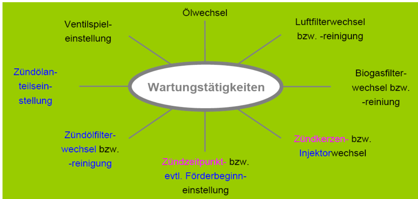
Abbildung 17: Auswahl von Wartungstätigkeiten für Gasotto- und Zündstrahlmotoren
