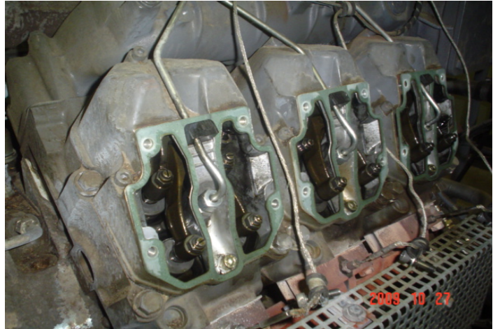
Abbildung 21: Zylinderköpfe vom BHKW mit der Datenbanknummer „76“ → „BF6M 1015 C“
