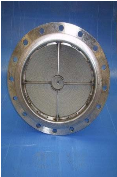
Abbildung 10: Washcoat im Träger eines AIR-SONIC-Kat. /15/
