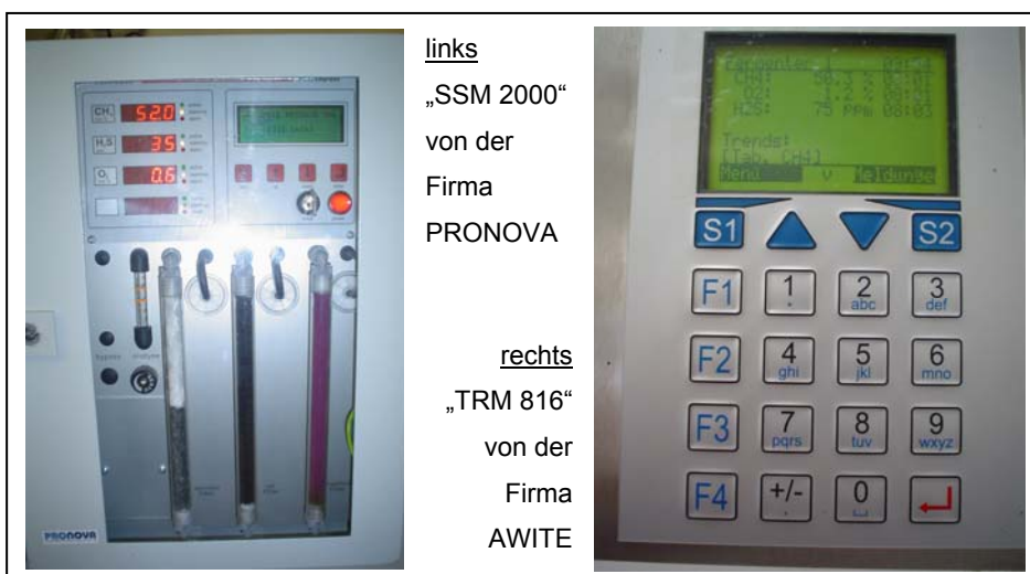
Abbildung 6: Beispiele stationärer Gasanalysegeräte in Pöhsig ( links ) und in Kotten ( rechts )
