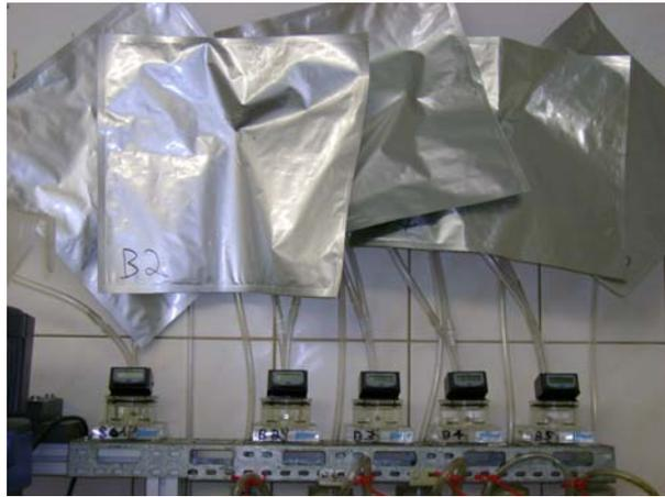
**Abbildung 2:** 2 l-Glasbehälter für Batch-Versuche mit Stopfenverschluss und Gas-schlauch (links), Milligasähler der Firma Ritter und Folienbeutel für die Gassammlung und -speicherung (rechts)
