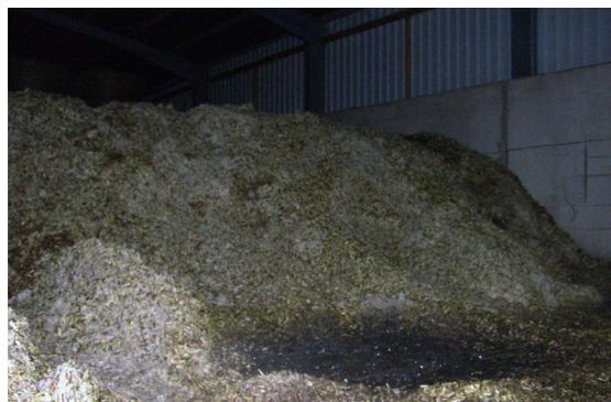
**Abbildung 32: Trocknung der Hackschnitzel in der Trockenhalle der Biogasanlage Bieberstein, Hackgut z. T. stark mit Eis und Schnee durchsetzt**
