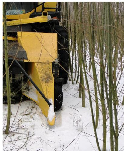
**Abbildung 24: Reifenschäden auf einer KUP bei Zschadras, Folge zu enger Reihenabstände**
