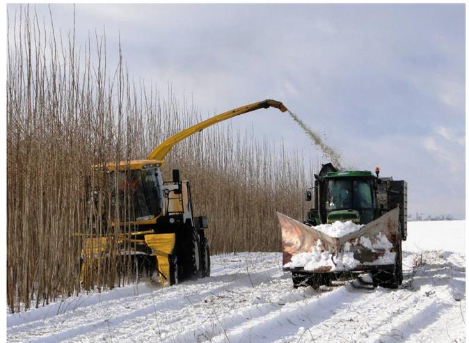
**Abbildung 21: Einzug zur Hacktrommel; Erntevorgang**
