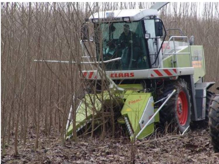
Abbildung 18: Jaguar-Häcksler mit Schneidvorsatz
