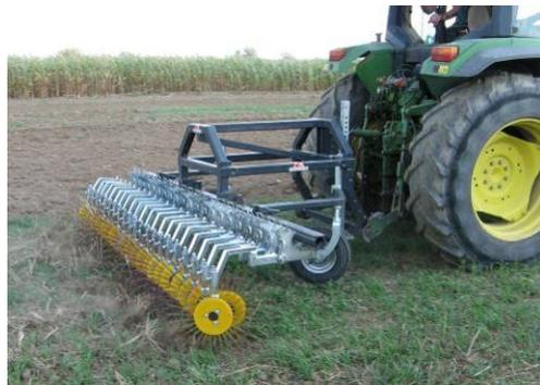
**Abbildung 4: Turbo-Roll-Striegel**
