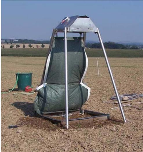
**Abbildung 6: Niederschlagssimulator;
