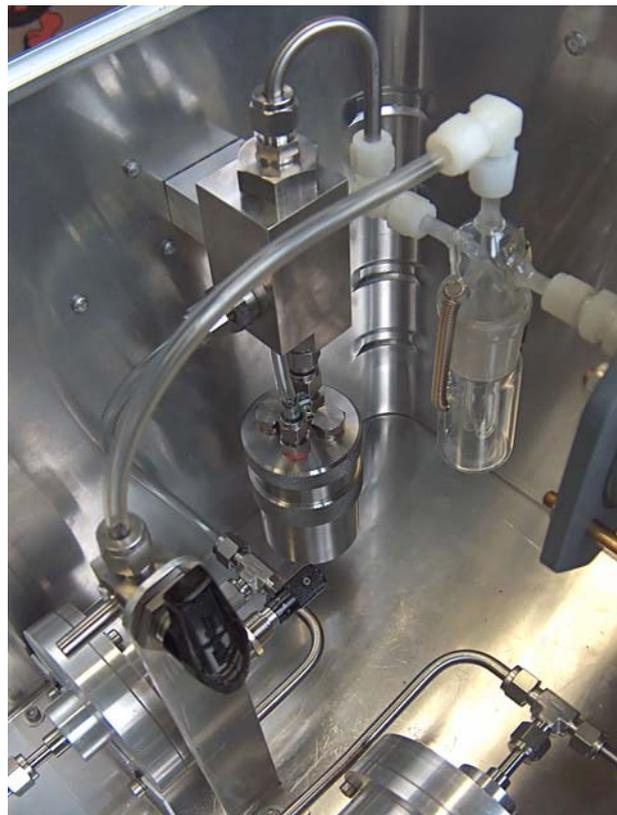
Abbildung 4: Detailansicht des Partikelgenerators (Zerstäubers)
