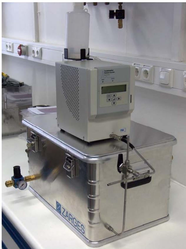
**Abbildung 7: Anschluss des Kondensationskernzählers an die Aerosolerzeugungseinheit**
