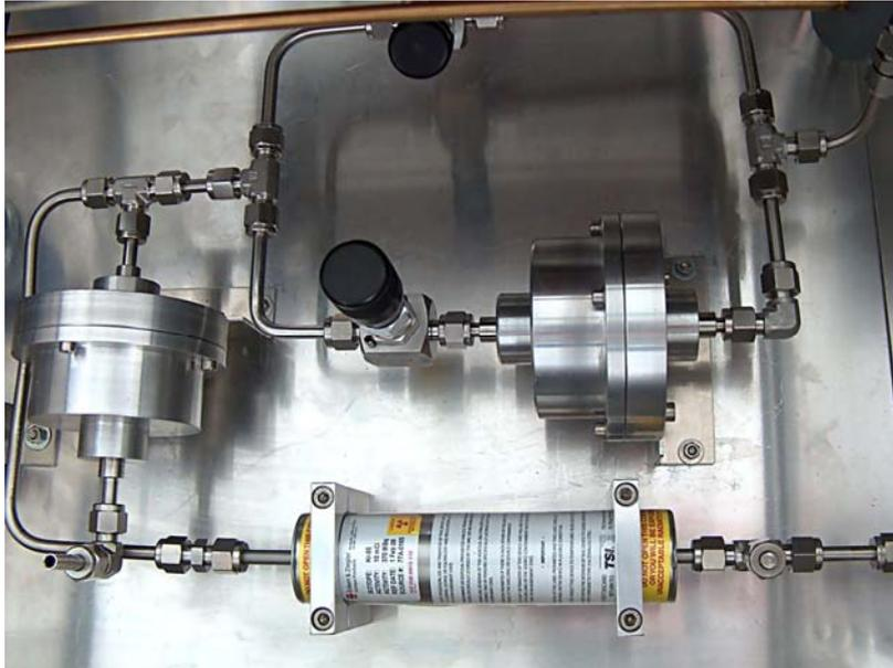
**Abbildung 6: Detailansicht des Neutralisators**
