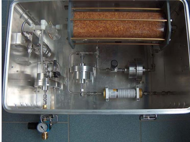
**Abbildung 3: Draufsicht Aerosolerzeugungseinheit**
