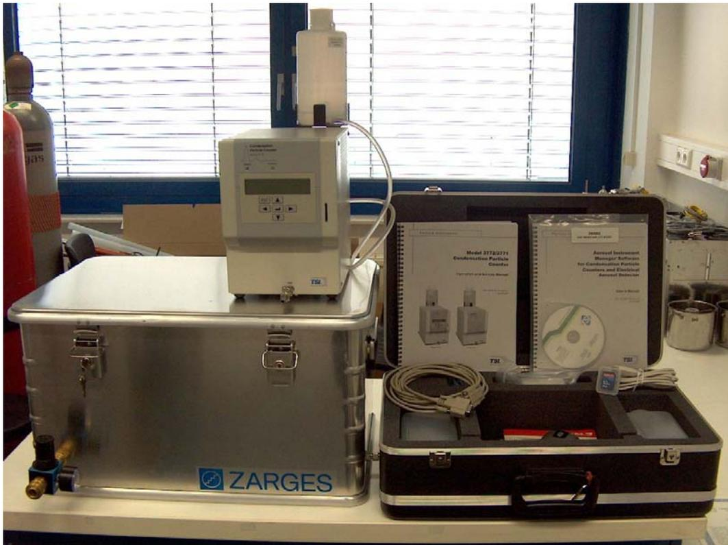
**Abbildung 1: Gesamtansicht des mobilen Aerosolstandards mit Aerosolerzeugungseinheit, Kondensationskernzähler (CPC) und CPC-Zubehörkoffer**
