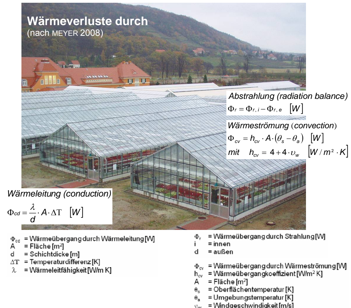
Abbildung 1: Wärmeübergänge an Gewächshäusern nach MEYER 2008
