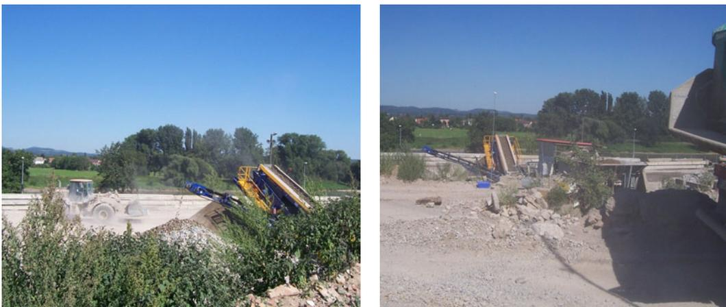
**Abbildung 38: Staubentwicklung bei Verzicht auf die Bewässerung der Fahrwege**
