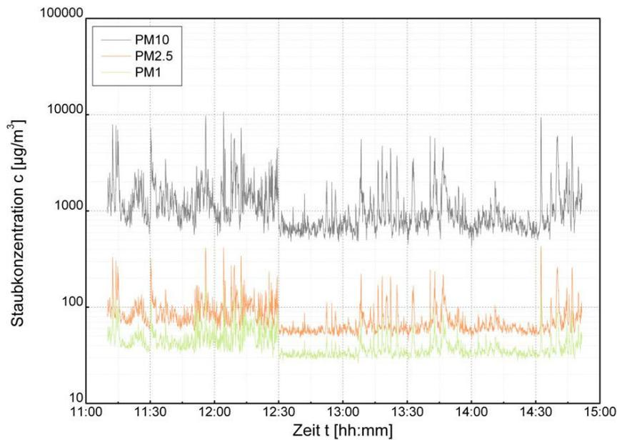
**Abbildung 23: (03.06.2009) kontinuierliche Bestimmung der Staubmassenkonzentration (Laser-Aerosolspektrometer Grimm 1.106)**
