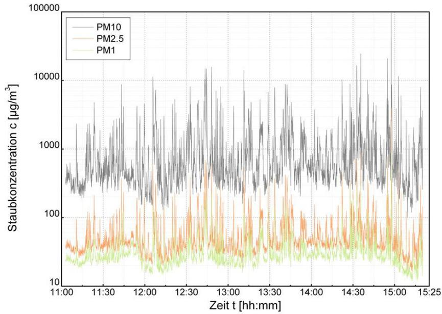
**Abbildung 28: (04.06.2009) kontinuierliche Bestimmung der Staubmassenkonzentration (Laser-Aerosolspektrometer Grimm 1.106)**
