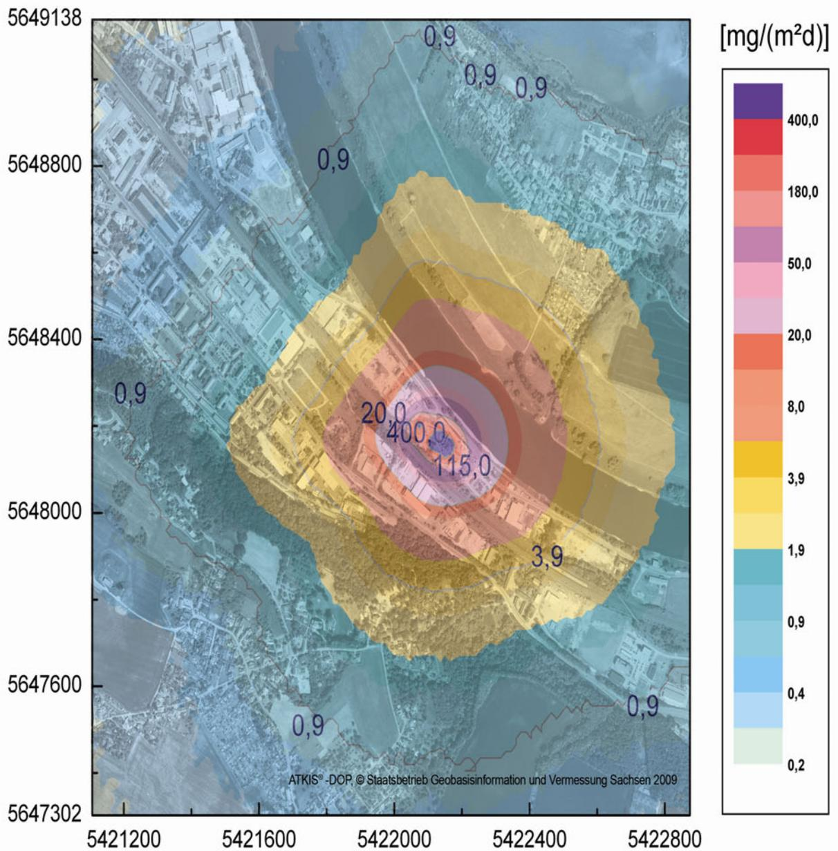
**Abbildung 59** Jahresmittelwert Staubdeposition (Zusatzbelastung), Betrieb ohne Bewässerung Fahrwege (Datei: pm-depz.dma)
