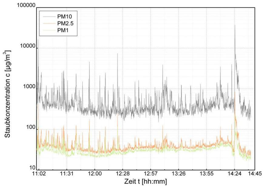
**Abbildung 18: (28.05.2009) kontinuierliche Bestimmung der Staubmassenkonzentration (Laser-Aerosolspektrometer Grimm 1.106)**
