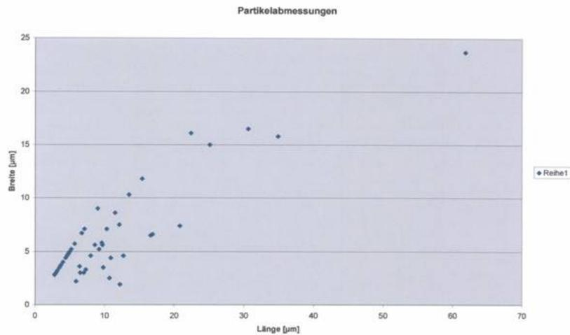
Abb. 5: Verteilung der Formfaktoren der ausgewerteten Partikel
