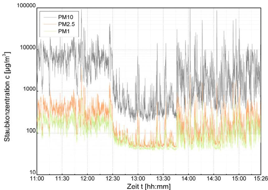
**Abbildung 34: (25.08.2009) kontinuierliche Bestimmung der Staubmassenkonzentration (Laser-Aerosolspektrometer Grimm 1.106)**
