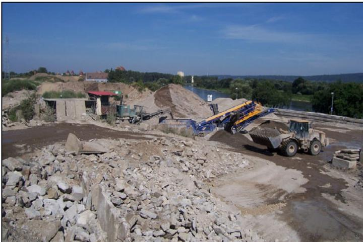
**Abbildung 32: Brecher mit neuer Siebmaschine, Messkampagne 3**
