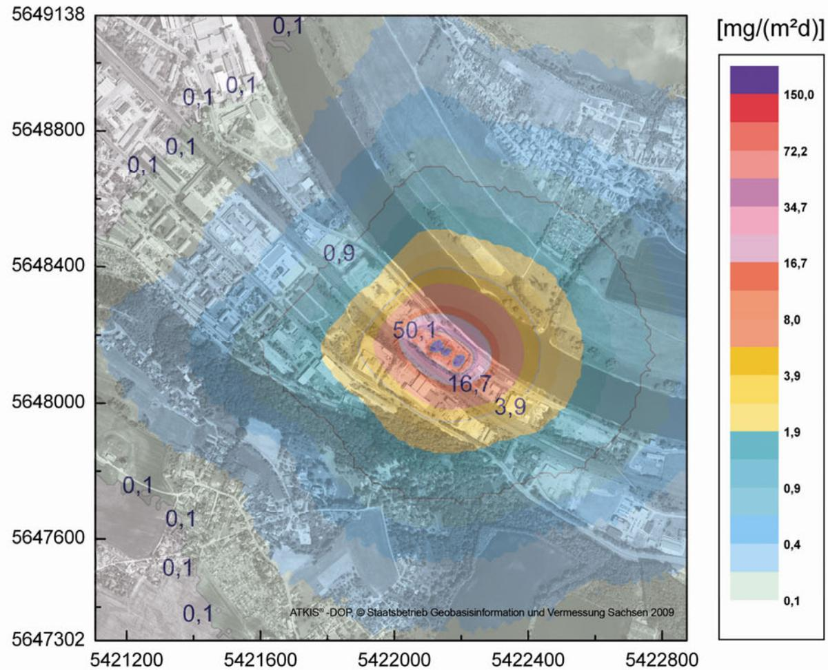
Abbildung 56 Jahresmittelwert Staubdeposition (Zusatzbelastung), bestimmungsgemäßer Betrieb (Datei: pm-depz.dma)
