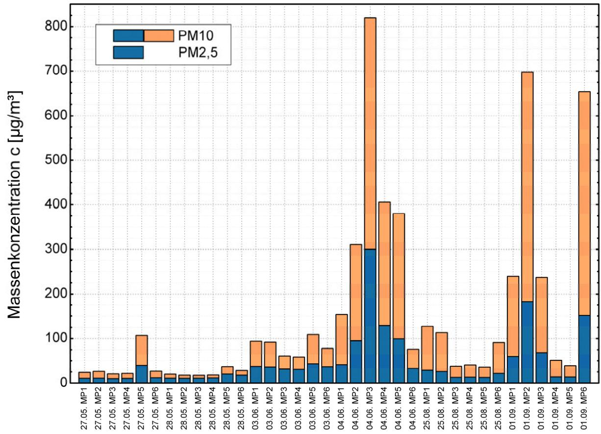
Abbildung 47: Mittlere PM2,5- und PM10-Massenkonzentrationen an den Messpunkten
