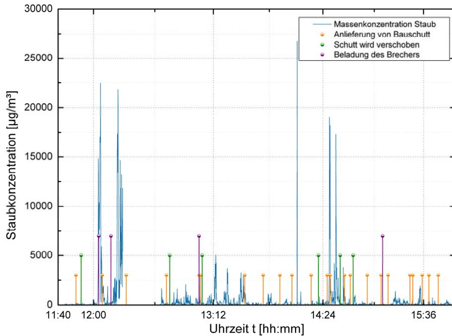
**Abbildung 7: Staubkonzentration im Untersuchungszeitraum, Laseraerosolspektrometer Grimm 1.108**
