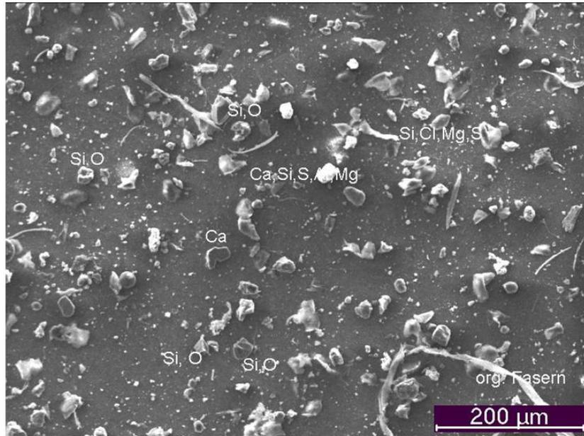
Übersichtsaufnahme des PC-Kernporenfilters mit typischen Partikeln
