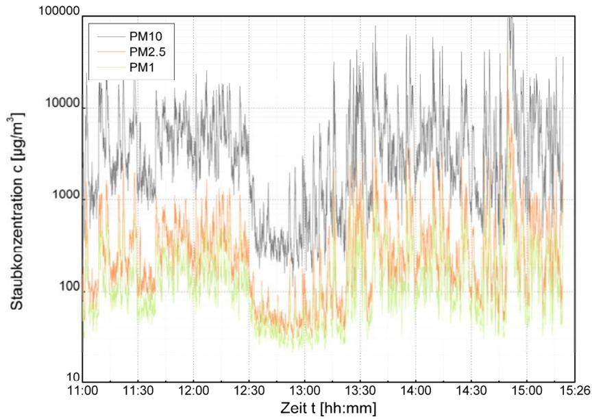
**Abbildung 40: (01.09.2009) kontinuierliche Bestimmung der Staubmassenkonzentration (Laser-Aerosolspektrometer Grimm 1.106)**
