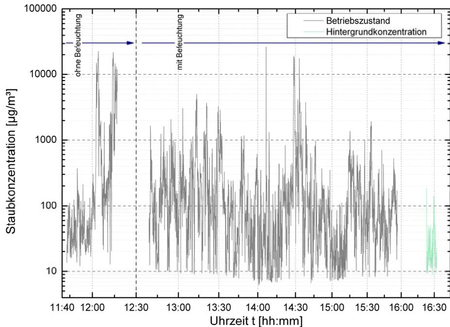
**Abbildung 8: Staubkonzentration im Untersuchungszeitraum, Laseraerosolspektrometer Grimm 1.108**
