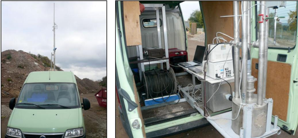
**Abbildung 4: Messfahrzeug mit Absaugereinheit und Messgeräten zur Partikelgrößenbestimmung**
