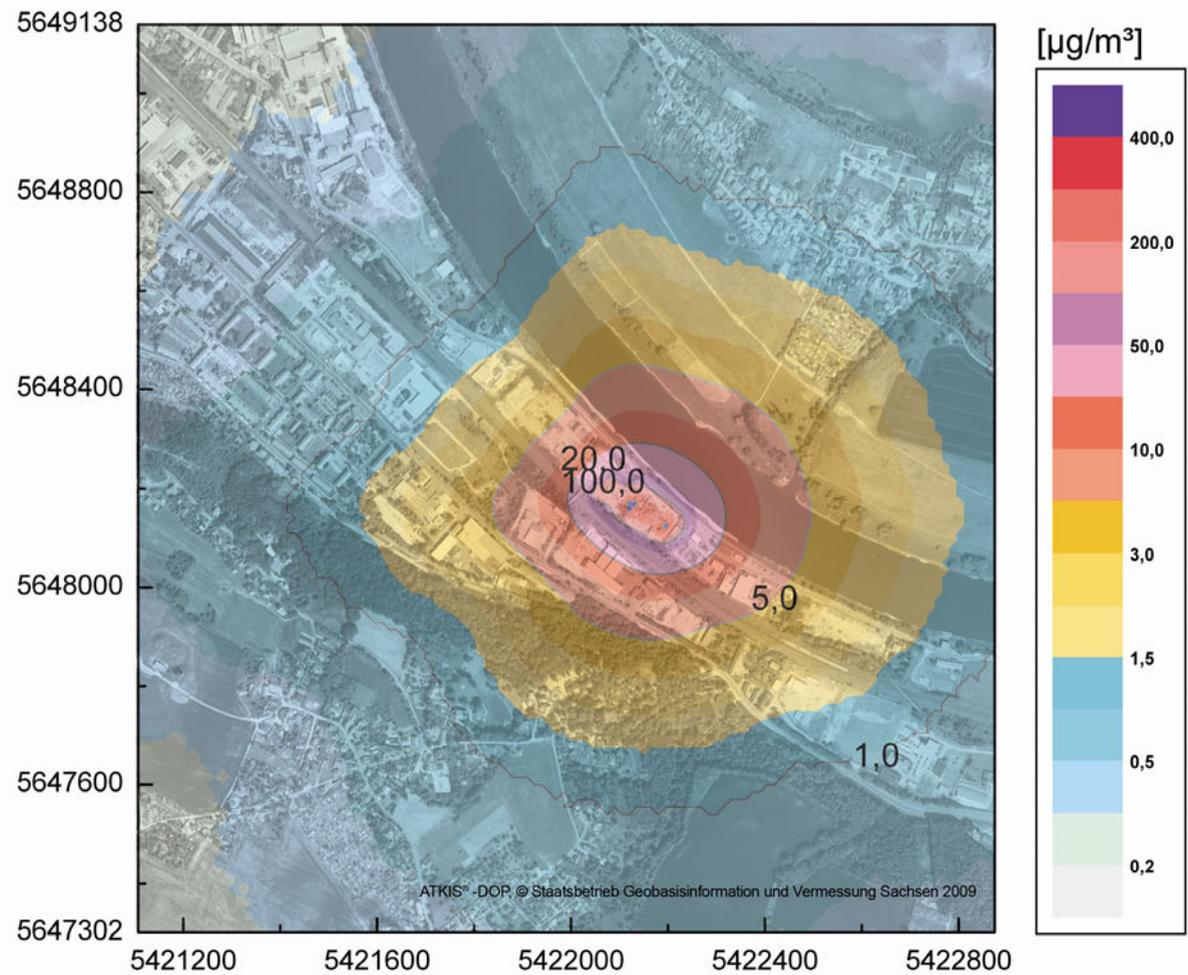
Abbildung 55: Jahresmittelwert Staubkonzentration (Zusatzbelastung), bestimmungsgemäßer Betrieb (Datei: pm-j00z.dma)
