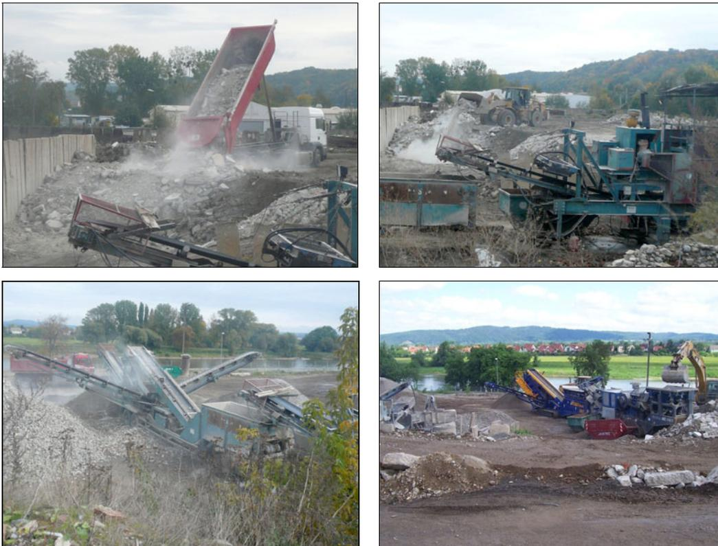
**Abbildung 2:** Anlieferung (links oben), Verschieben des Bauschutts (rechts oben), Staubentwicklung beim Brechen von armierten Betonteilen (Berieselung aus, links unten), Beschickung Brecher (rechts unten)
