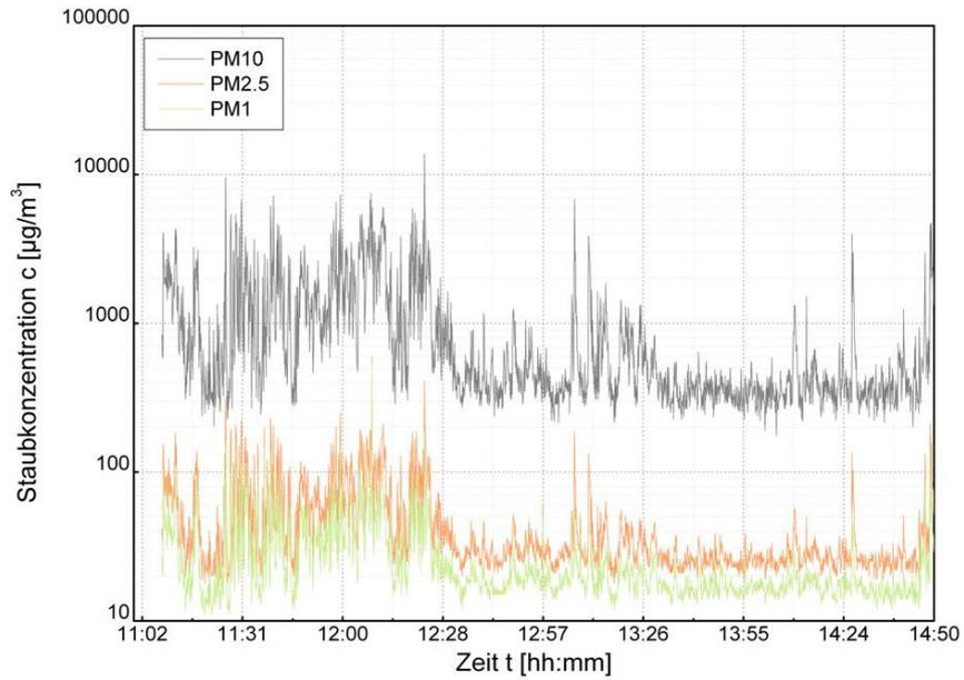
Abbildung 13: (27.05.2009) kontinuierliche Bestimmung der Staubmassenkonzentration (Laser-Aerosolspektrometer Grimm 1.106)
