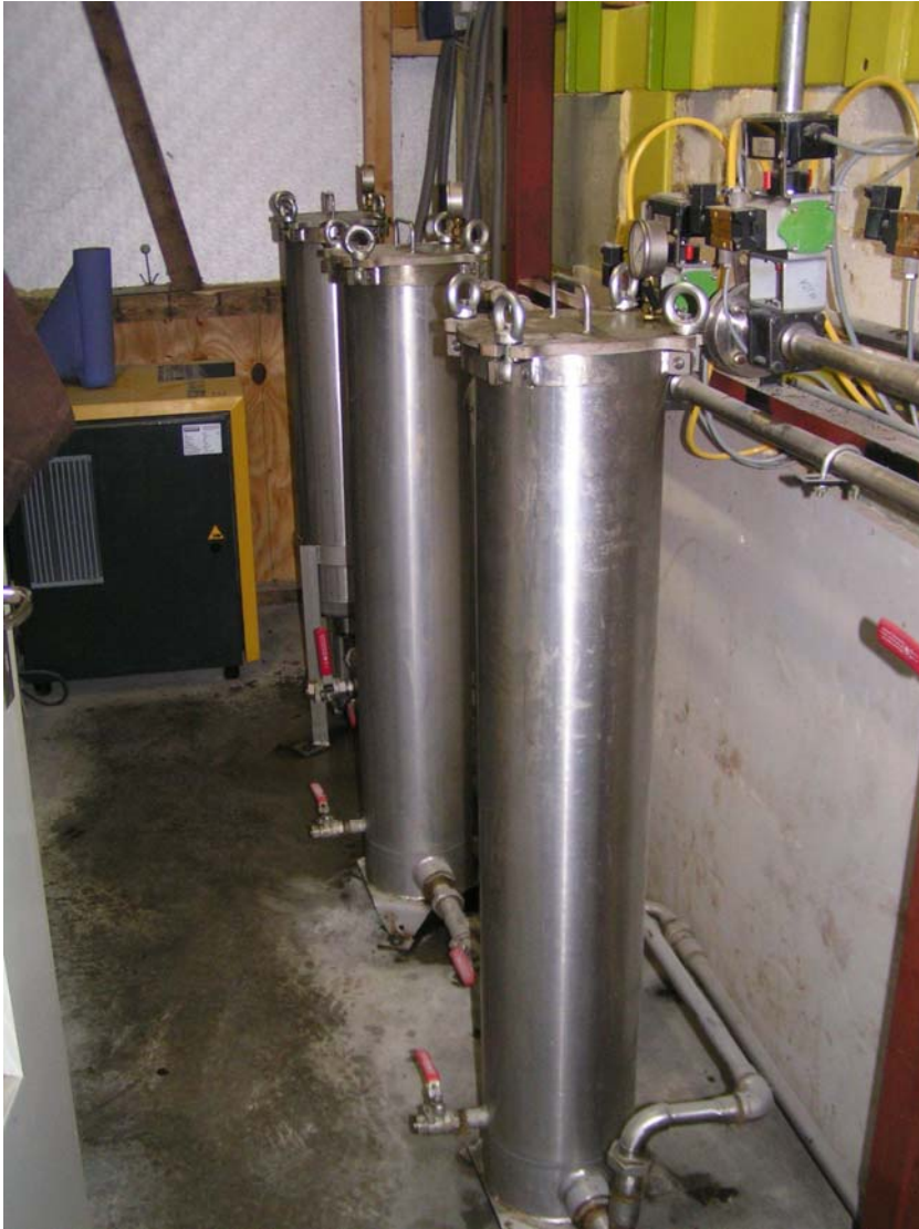
Abbildung 3: Beutel- und Kerzenfilter der Ölmühle der AG „Bergland“ Clausnitz e.G. (Foto: T. Krüger)
