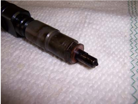
Abbildung 15: Einspritzdüse JD 7430, 1.750 Bh, Rapsölbetrieb
