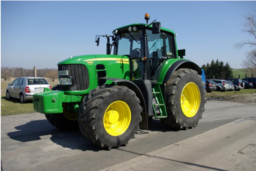
Abbildung 13: Umgerüsteter Traktor John Deere 7530, 203 PS (1-Tanksystem) für Rapsölkraftstoff der AG „Bergland“ Clausnitz e.G., Laufleistung 2.500 Bh (Foto: E. Ferchau)
