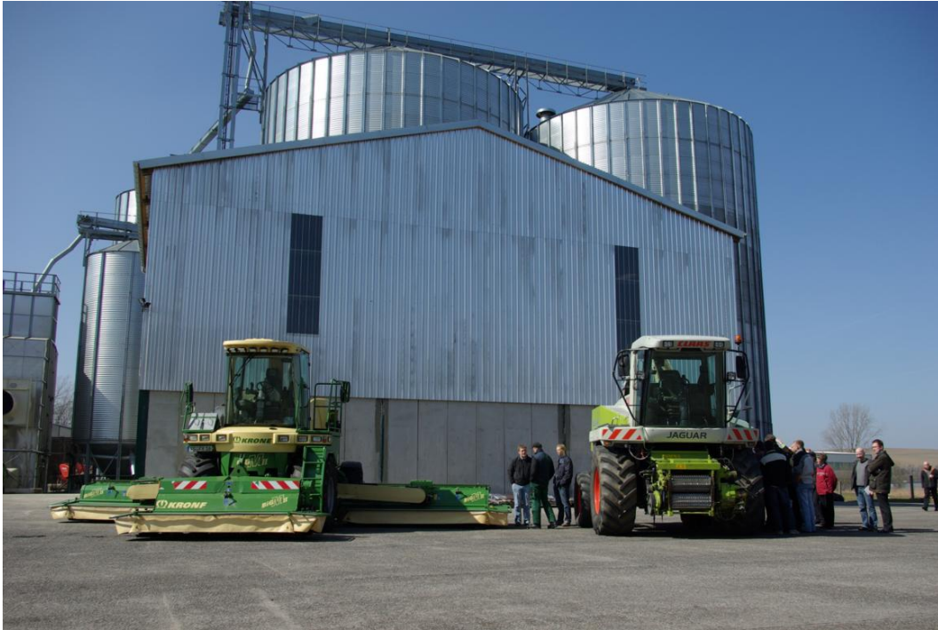
Abbildung 16: Selbstfahrmäherwerk Krone Big M II und Häcksler Claas Jaguar 870 (jeweils 2-Tanksystem) angepasst auf Rapsölkraftstoff, Agrargenossenschaft „Bergland“ Clausnitz e.G.
