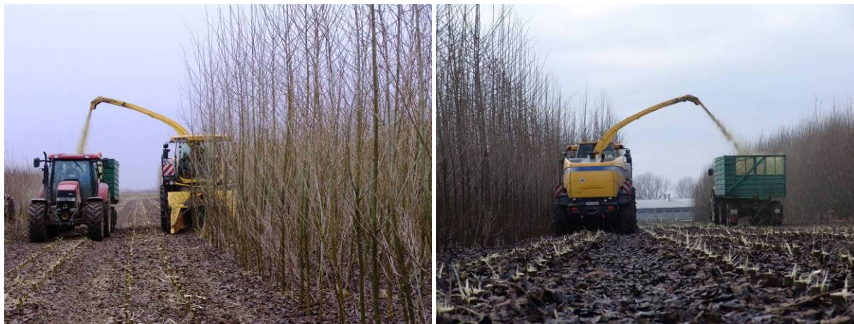
Abbildung 55, 56: Ernte von Pappelflächen mit Vollernter der Firma New Holland mit Holzerntevorsatz 130 FB am 03.02.2011 in Köllitsch
