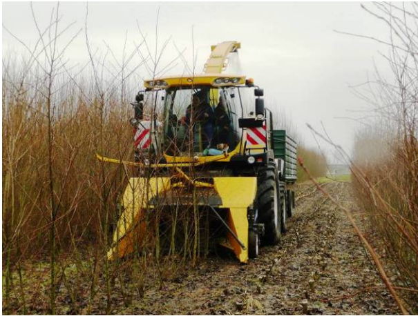
Abbildung 53: Vollernter der Firma New Holland mit Holzerntevorsatz 130 FB, Ernte am 03.02.2011 in Köllitsch
