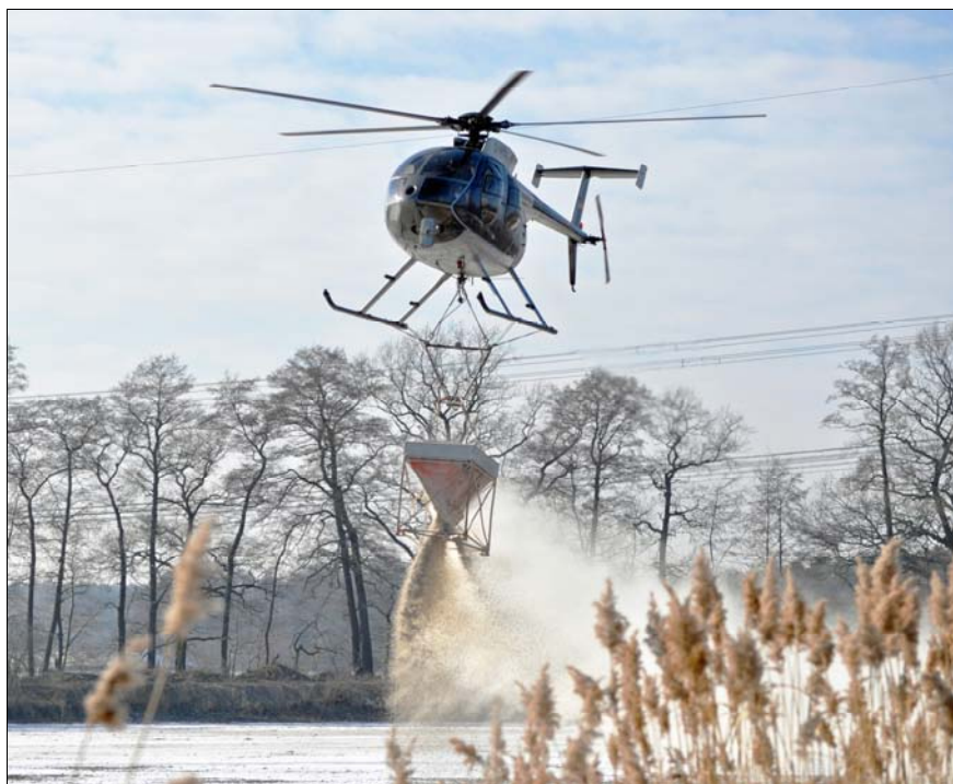
Abbildung 2: Kalkung zur Teichsanierung mittels Hubschrauber
