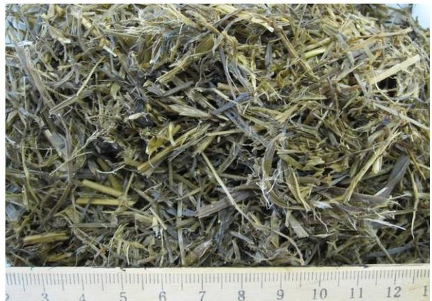
**Abbildung 24: Grünroggsilage vor und nach Zerkleinerung mit Querstromzerspaner (3 sec Zerkleinerungszeit)**
