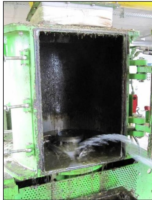
**Abbildungen 21 + 22: Querstromzerspaner und Kettenschlagwerk**
