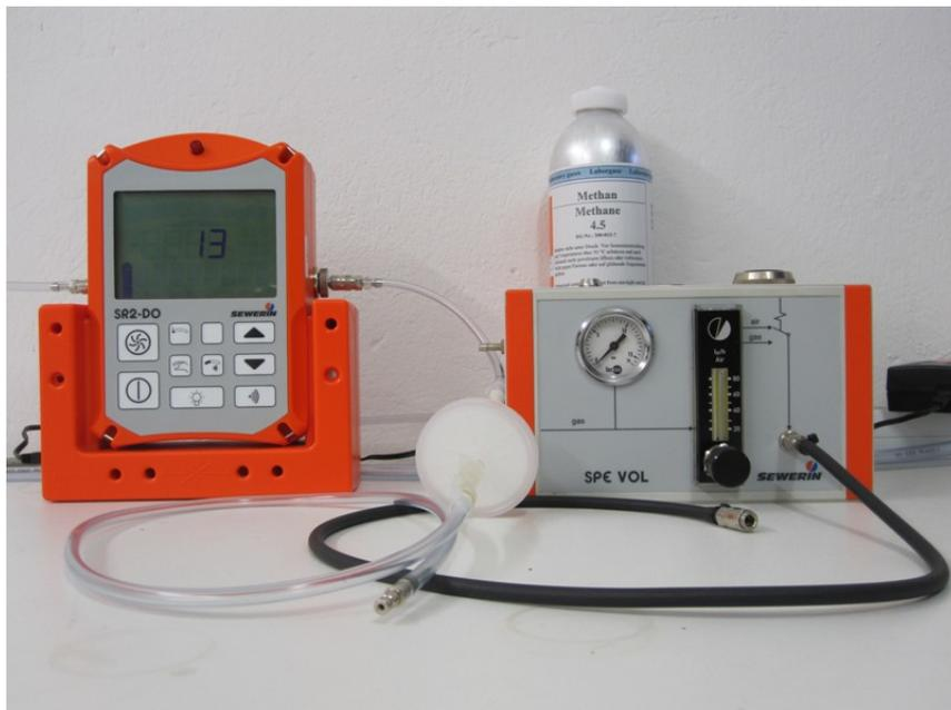
**Abbildung 12: Mehrkanal-Gasanalysator**
