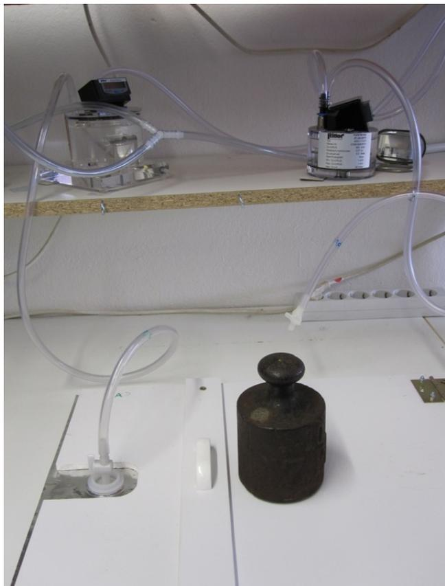
**Abbildung 7: Gasvolumenmessung mit Kippzähler (Auspressen der Biogasauffangbeutel mittels Gasbeutelklappe)**
