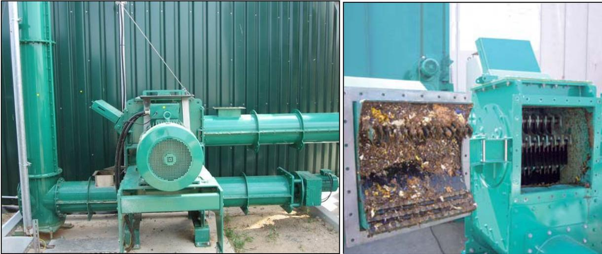
**Abbildung 17 + 18: Hammermühle und Arbeitsraum**
