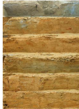
Abb. 3: Schichtenaufbau kontaminiertes Substrat Lysimeter 4 (3,5 - 5,0 m u. GOK von oben nach unten)
