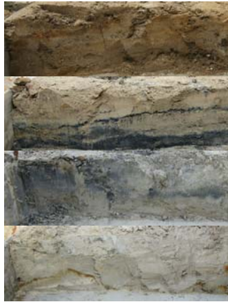
Abb. 2: Schichtenaufbau kontaminiertes Substrat Lysimeter 2 (2 - 3 m u. GOK von oben nach unten)
