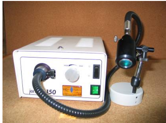
Abbildung 4: Lichtquelle mit Lichtleiter und Spezialfilter für Eibonitur
