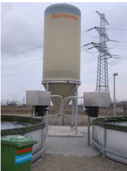
Abbildung 6: Fütterungsanlage mit Turbinen zur Futterausbringung und Futtersilo
