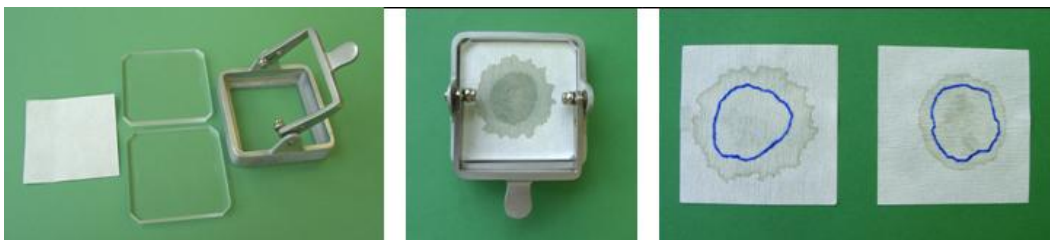
Abbildung 4: Bestimmung des Presssaftverlustes nach GRAU & HAMM mit dem Braunschweiger Besteck
