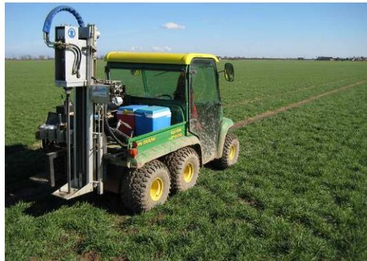
**Abbildung 104: Bohrgerät zur GPS-gestützten Bodenprobenahme**
