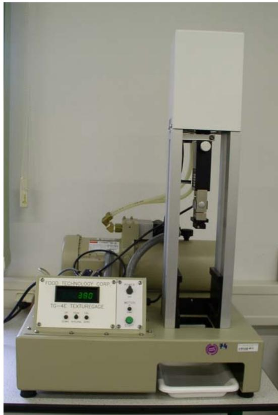
Abbildung 7: Tenderometer (FTC, Modell TM2)
