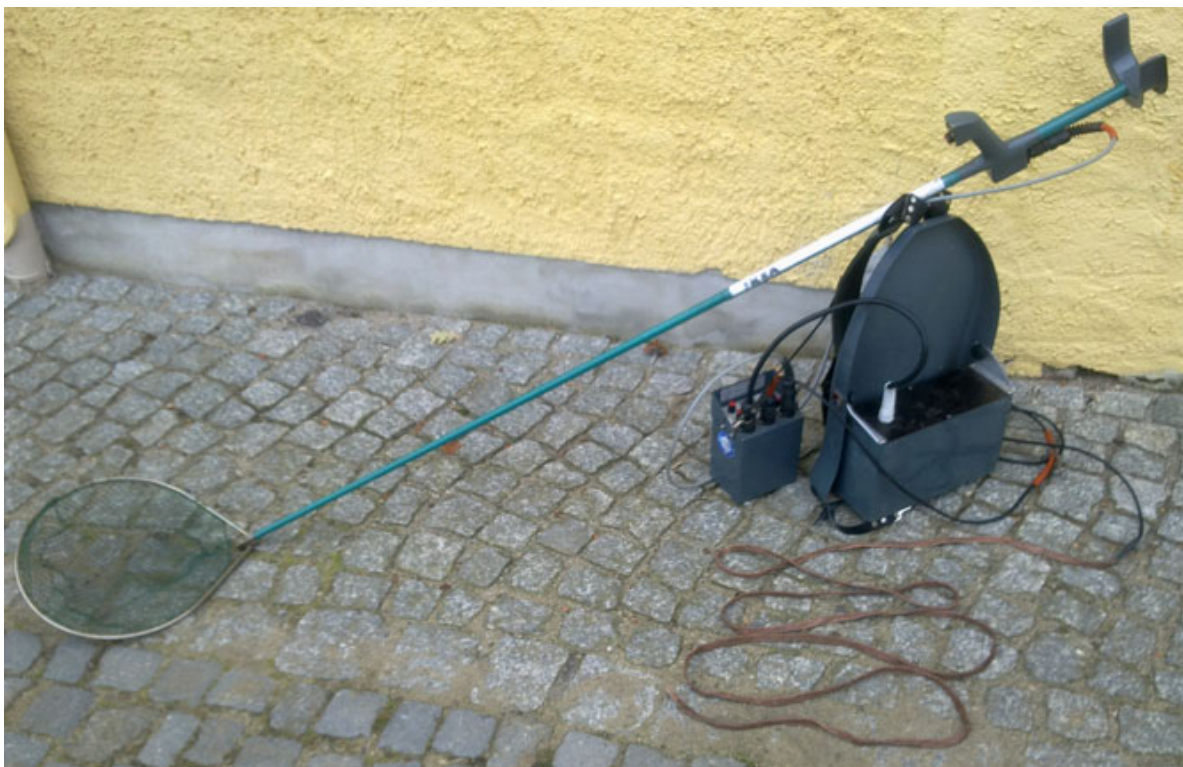
Abbildung 26: Elektrofischfanggerät Typ EFGI 650 mit Anode, Kathode und Steuergerät
