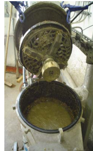
Abbildung 18: Zerkleinerer „RotaCut 5000“ der Firma Hugo Vogelsang Maschinenbau GmbH Essen (bei Oldenburg)
