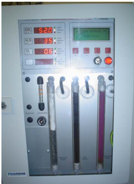
Abbildung 12: Beispiele stationärer Gasanalysegeräte in Pöhsig ( links ) u. in Kotten ( rechts )
