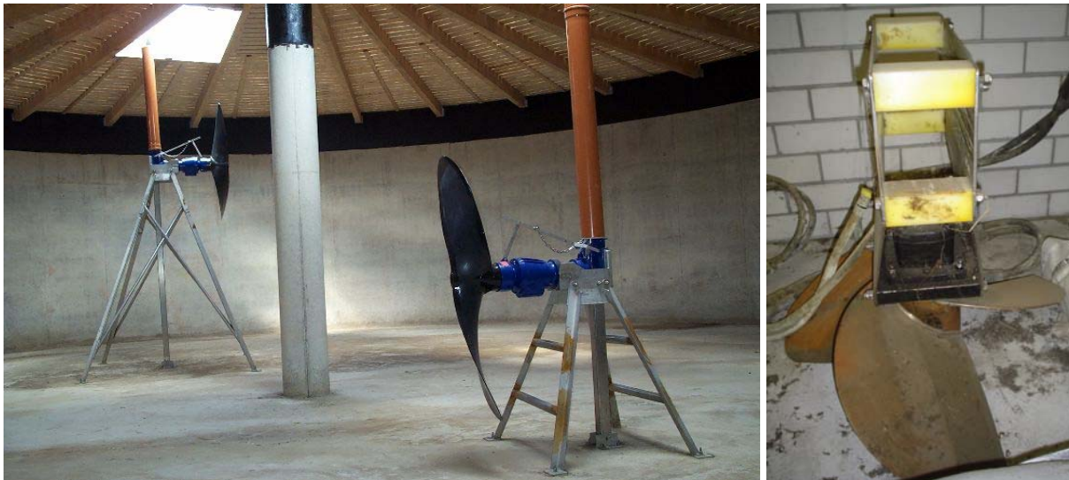
Abbildung 26: Höhenverstellbares BioProp-Fermenterrührwerk der ROTARIA Energie- und Umwelttechnik GmbH Rerik /27/ ( links ) und hydraulisch angetriebenes Tauchmotorrührwerk ( rechts ) für die Biogasanlage beim Landwirtschaftsbetrieb Philipp GbR Großweitzschen, Ortsteil Strölla (Landkreis Mittelsachsen)
