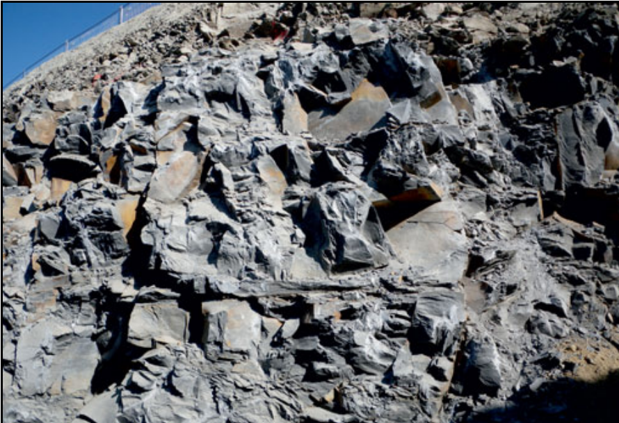
Abbildung 56: Subhorizontale Scherzonen im Pläner (die Scherzonen umschließen phakoide Körper)
