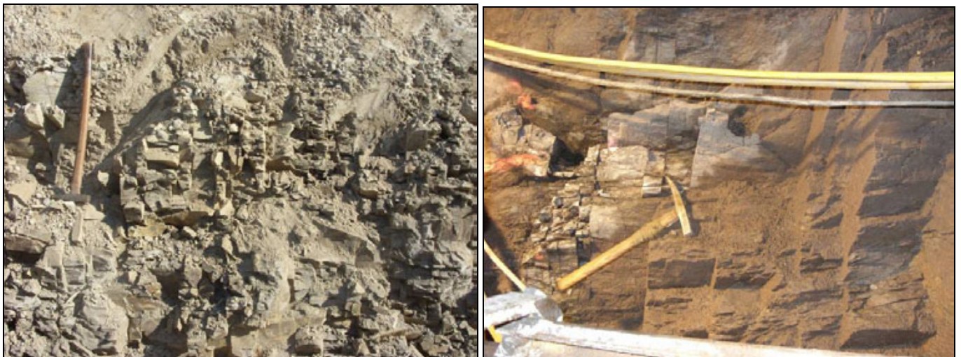
Abbildung 59: Junge Kluftezonen mit äquidistanten steilen Klüften im Pläner nördlich von Weinböhl (links) und im Porphyrit des Wismutstolln in Freital-Potschappel (rechts)
