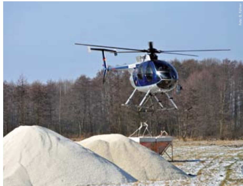
Ausbringung von Branntkalk mit dem Hubschrauber für die Teichdesinfektion
