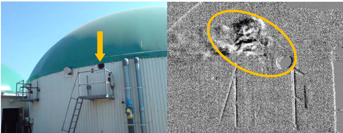
Abb. A.6.4: Gasaustritt Bullauge Fermenter 2
