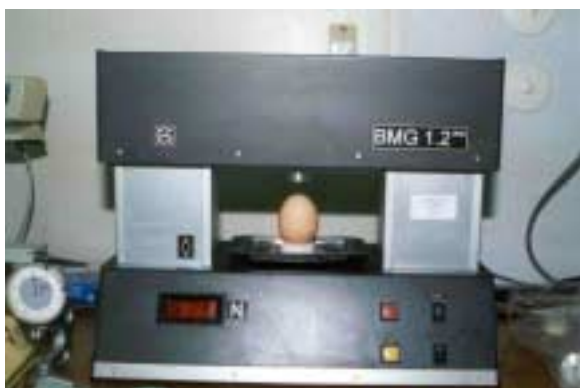
Abb. 2: Meßgerät zur Bestimmung der Eischalenstabilität
