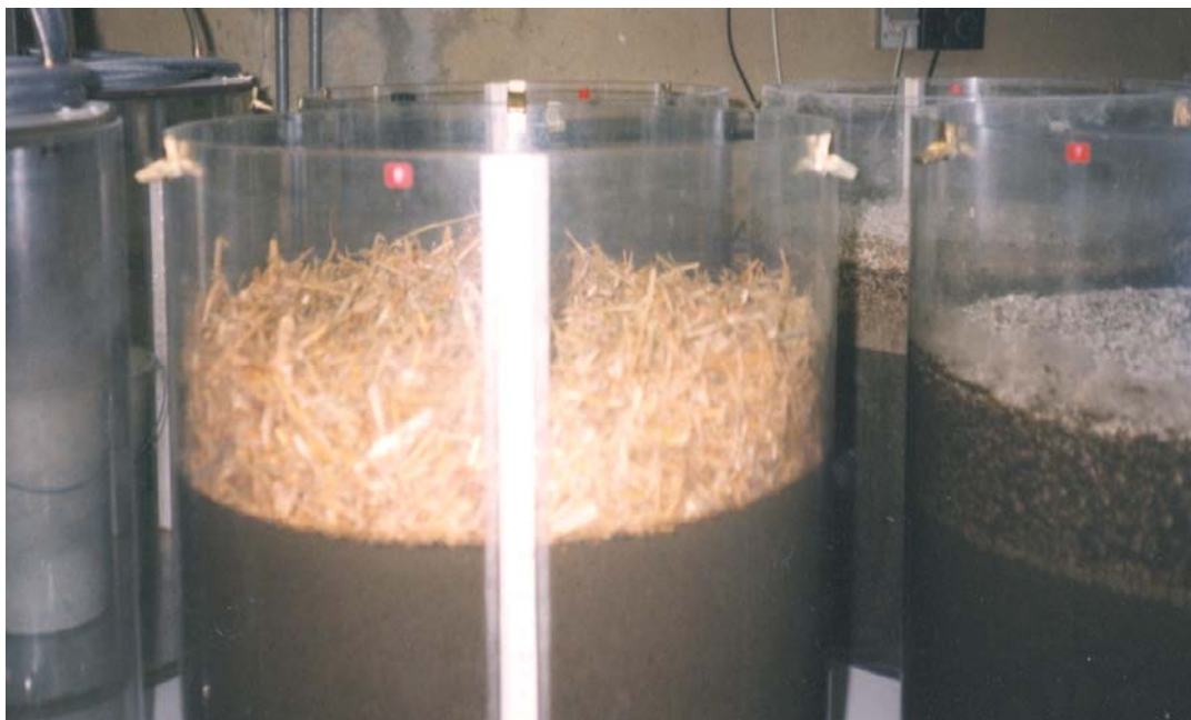
Foto 1: Versuchsbehälter zur Bestimmung der Geruchsstofffreisetzung und des
