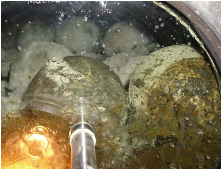
Abbildung 4-4: Schwimmkugeln zur Oberflächenvergrößerung der Entschwefelungszone
