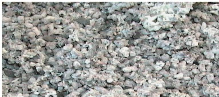
Abbildung 1: Asche aus der Verbrennung von Holzpellets
