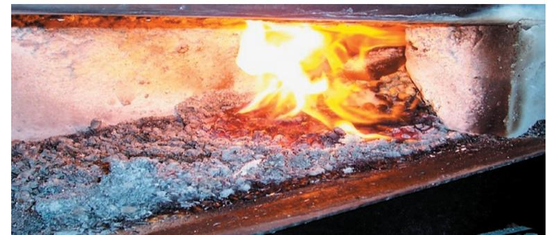
Abbildung 2: Verbrennungsraum mit Glutbett und Asche
