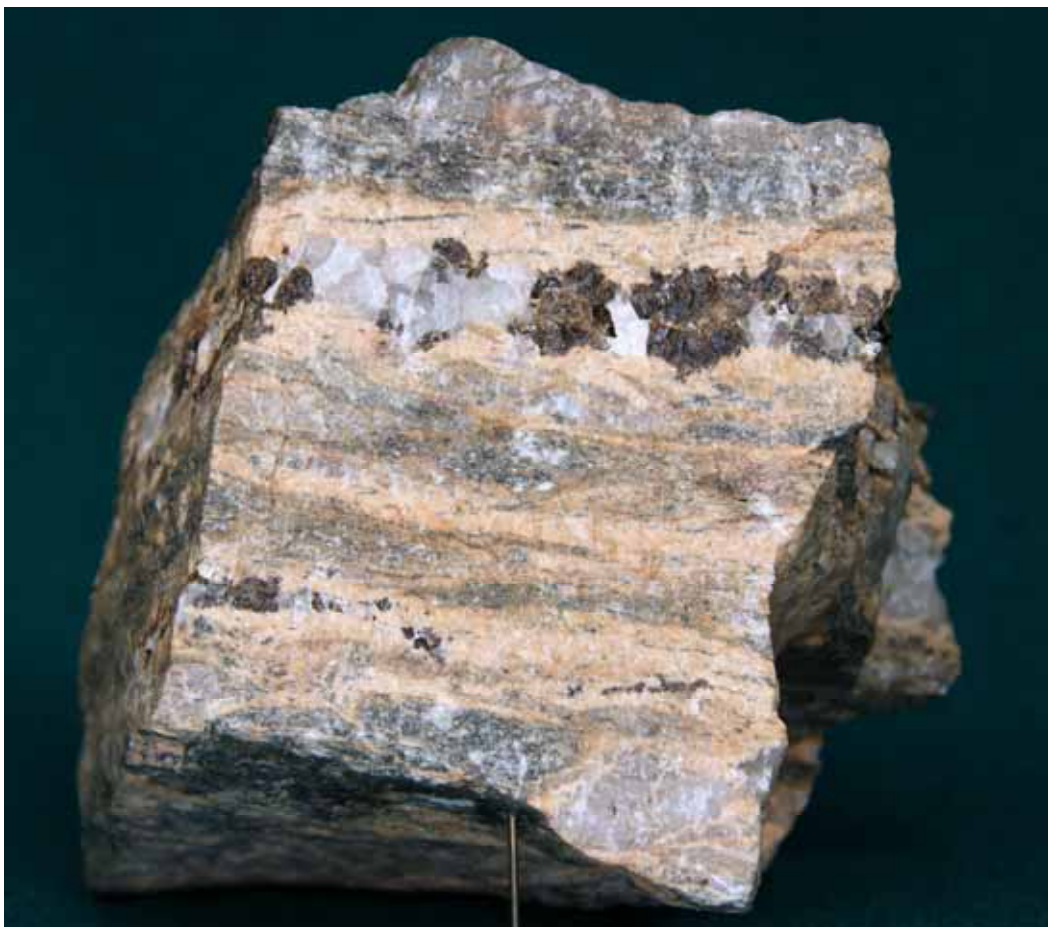
Abb. A6-4: Kassiterit in Quarz-Feldspat-Trümmern (Hämmerleiner Schiefererz); Bildbreite 12 cm
