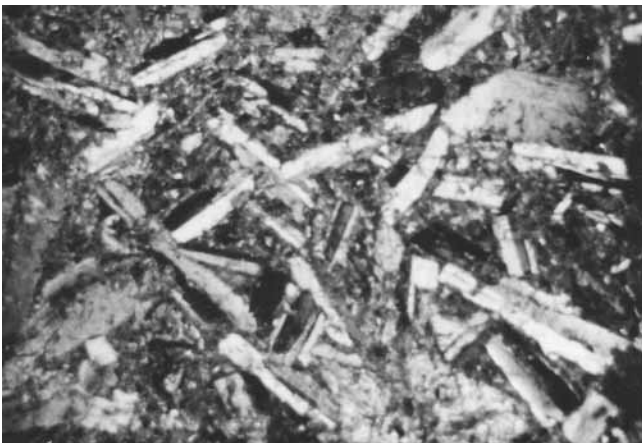
Abb. 2-17: Lamprophyr (Minette) mit Biotit zwischen den Plagioklasleisten; Brl. E 78/1967 bei 616 m; Bildbreite 4 mm; Nic.+
