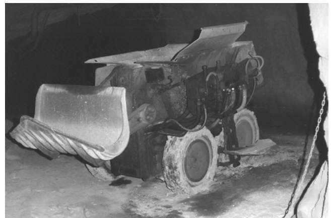
Abb. 7-2: Druckluftbetriebener Bunkerlader LS 125 auf der +150 m-Sohle
