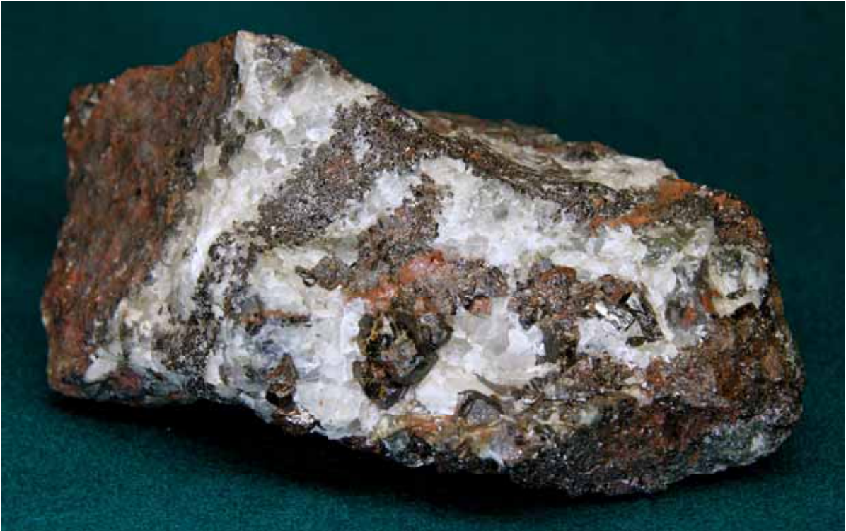
Abb. A6-3: Kassiterit mit Quarz im Amphibolskarn aus dem Hämmerlein-Lager; Bildbreite 10 cm
