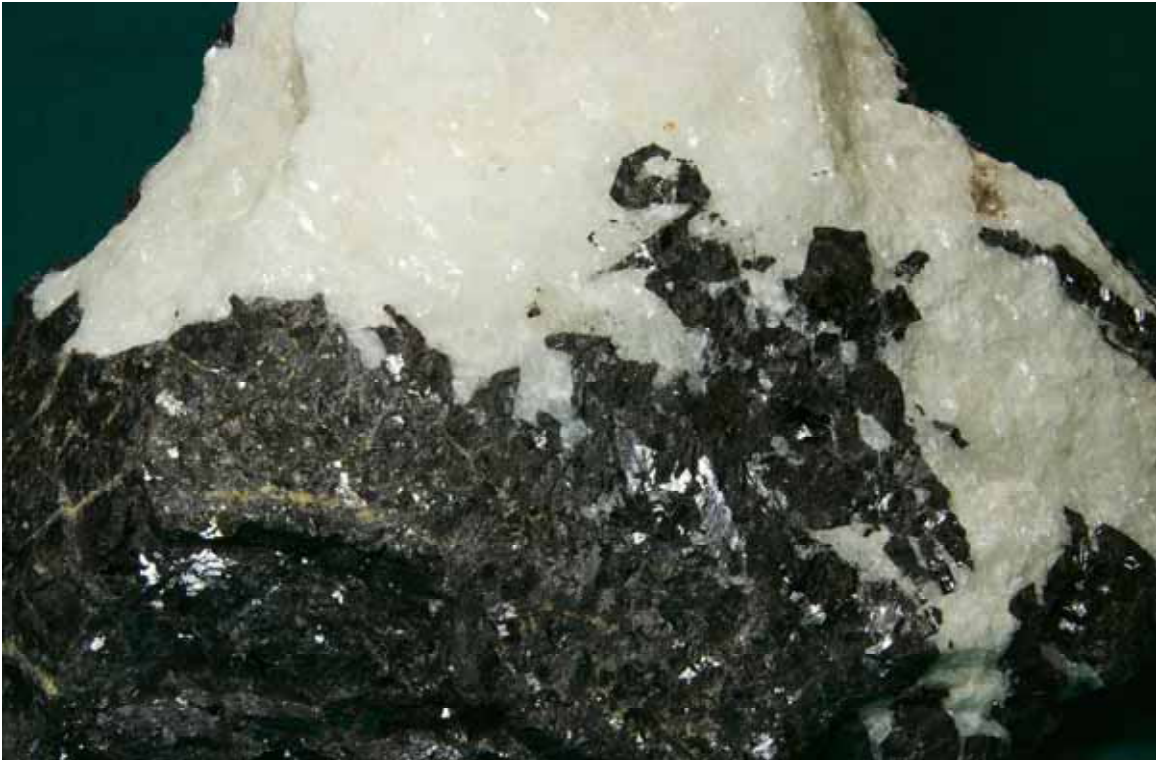
Abb. A6-5: Sphalerit mit Calcit aus dem Skarnlager „Hämmerlein“; Bildbreite 30 cm
