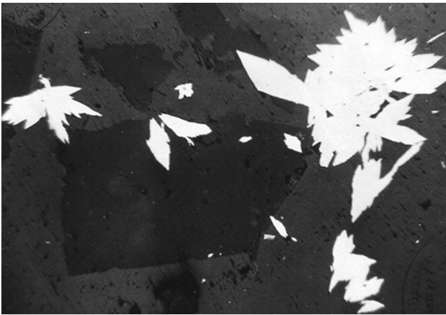
Abb. 2-44: Rhombische Arsenide in einem Baryt-Karbonat-Gang; Strecke 1204 bei 9 m; Bildbreite 0,6 mm
