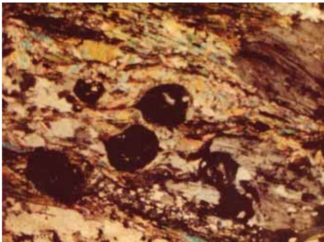
Abb. 2-15: Kohlenstoffführender Granat-Albit-Muskovit-Schiefer; Brl. E 108/1967 bei 167 m; Bildbreite 3,3 mm; Nic.+
