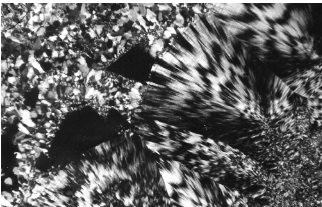
Abb. 2-36: Chalcedon-Sphärolithe mit aufgewachsenem Fluorit (schwarz) und Quarz; Strecke 16 b -16 c ; Bildbreite 4,2 mm; Nic.+
