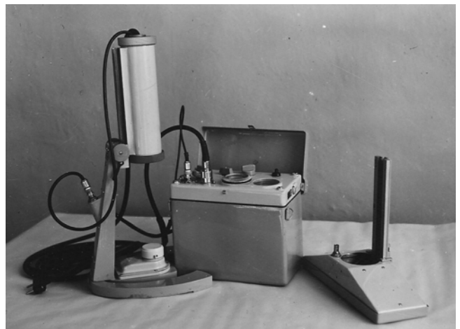
Abb. 4-2: Gerät zur kernphysikalischen Zinn-Gehaltsbestimmung im Labor MAK-1
