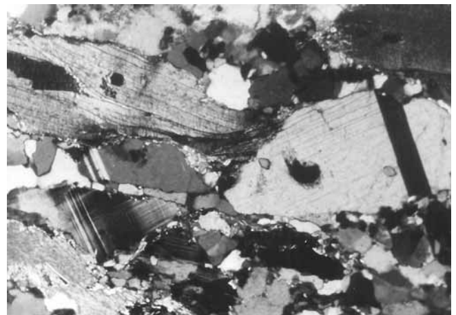
Abb. 2-6: Muskovitgneis mit gegittertem Mikroklin; Brl. E 12/1966 bei 256 m; Bildbreite 1,4 mm; Nic.+
