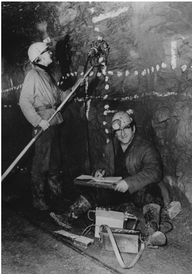
Abb. 4-3: Einsatz des Gerätes Romul-EFA-P zur Zinn-Gehaltsbestimmung am Anstehenden
