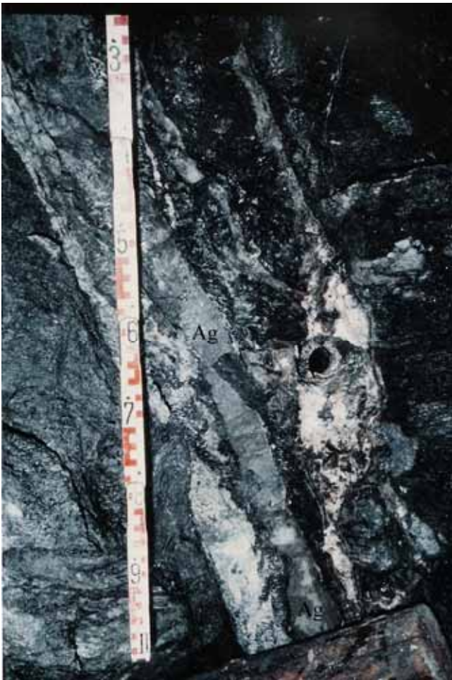
Abb. 8-2: Abbaublock 0985 mit reicher Silbervererzung (Ag) im liegenden Teil des Ganges
