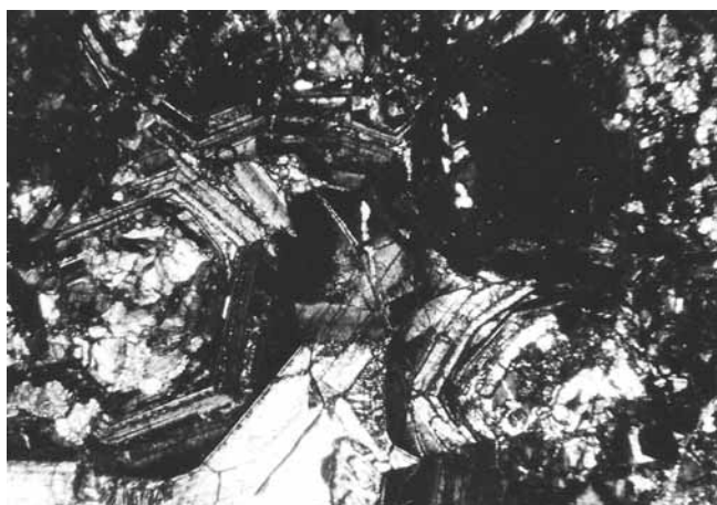
Abb. 2-26: Granat-Epidot-Amphibol-Skarn mit zonar gebautem, anisotropem Granat; Brl. E 82/1967 bei 861 m; Bildbreite 1,4 mm; Nic.+
