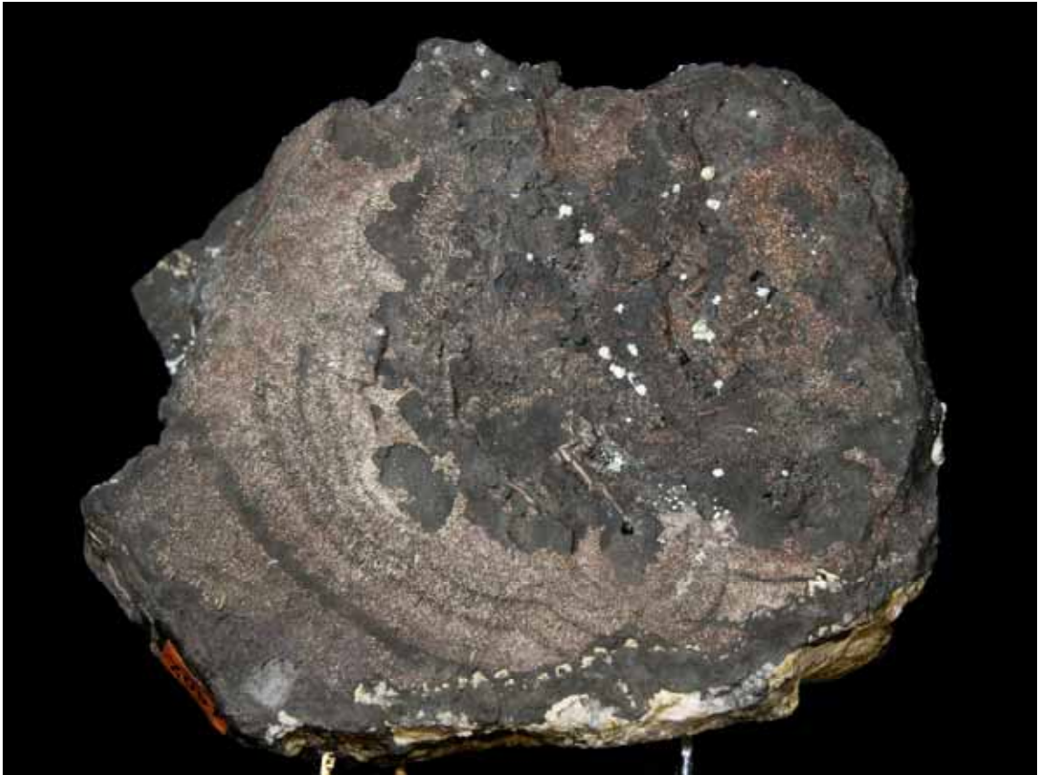
Abb. A6-11: Konzentrische Anreicherungen von gediegen Silber in gediegen Arsen vom gleichen Vorkommen; Bildbreite 14 cm
