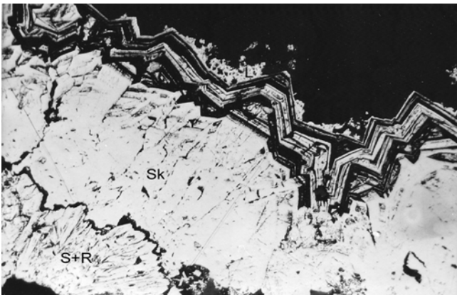
Abb. 2-45: Zonar gebaute Skutteruditkristalle (Sk) mit etwas Löllingit (L), aufgewachsen auf Safflorit-Rammelsbergit (S+R); Feld-Strecke 9202 bei 290 m; Bildbreite 1,2 mm
