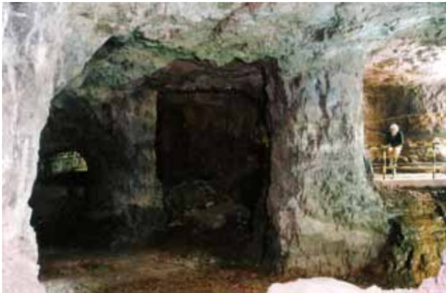
Abb. 7-5: Kammerpfeilerbau im Experimentalblock 7542
