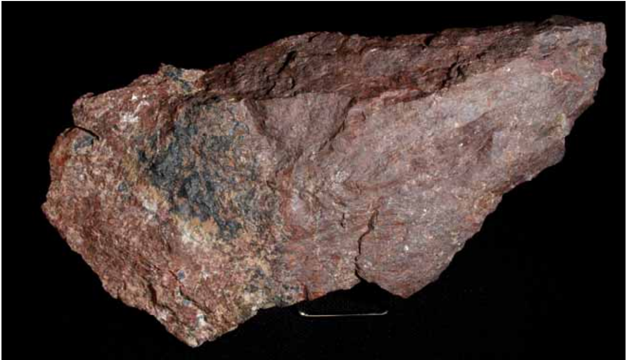
Abb. A6-7: Pechblende mit Dolomit und rotem Hornstein vom Gang „Schildbach“/Tellerhäuser; Bildbreite 30 cm
