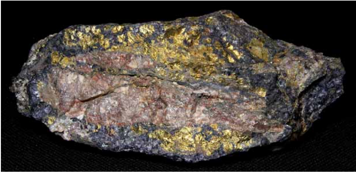
Abb. A6-9: Pechblende mit Fluorit (Stinkspat) und Chalkopyrit von „Kunnerbach“/Tellerhäuser; Bildbreite 10 cm
