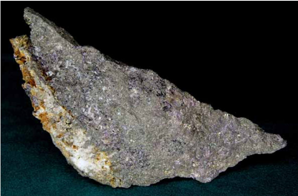
Abb. A6-12: Verwachsung von gediegen Wismut und Fluorit mit Quarz vom Gang „Kunnersbach“; Bildbreite 20 cm
