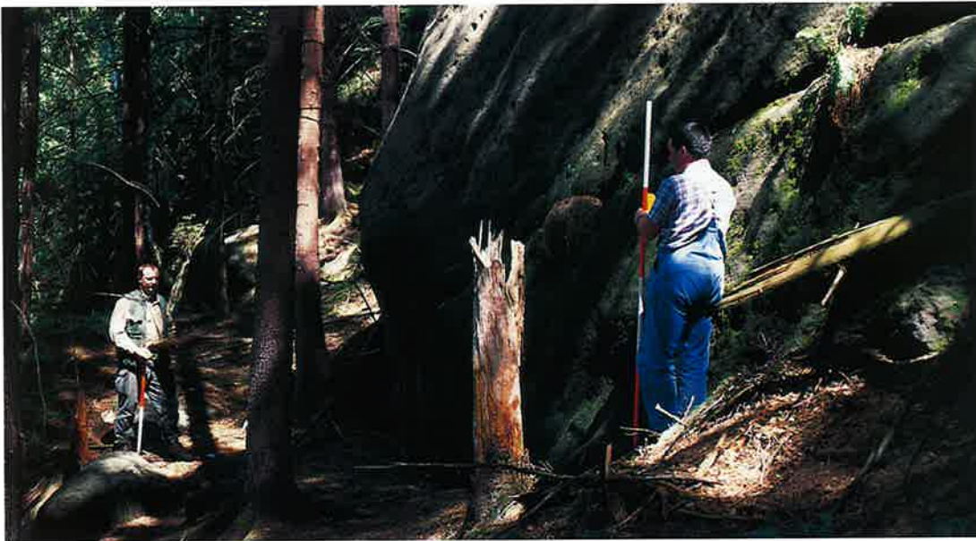
Abb. 2: Einmessung einer Probefläche im Zwei- manntrupp: Auf der Basis der in der Karte ermittelten Richtungs- und Ent- fernungsdaten wird die Einmessung im Gelände mit Hilfe von Fluchtstab, Kompaß und Ultraschallent- fernungsmesser vor- genommen
