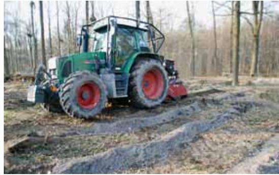
Abb. 5: Fräsen von Pflanzstreifen mit gleichzeitiger Kalkeinbringung
