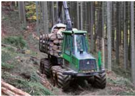
Ein Forwarder transportiert auf einem Maschinenweg verschiedene Holzsortimente zu einem LKW-befahrenen Abfuhrweg
