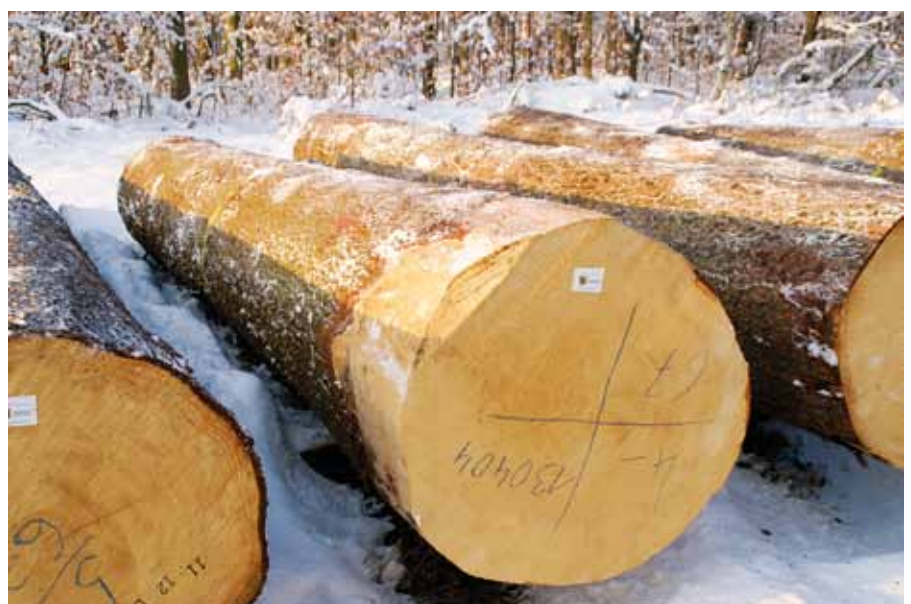
Abb. 13: Perfekt ausgehaltene Fichte; Länge, Durchmesser und Stammnummer angeschrieben, Wurzelaufläufe beigeschnitten, Mitte markiert
